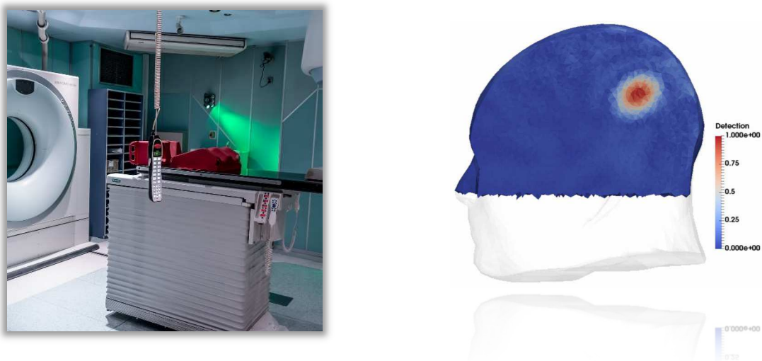
Figure 6.1 e 6.2 Diagnostica per immagini a microonde: Dispositivo portatile e ricostruzione tomografica risultante
