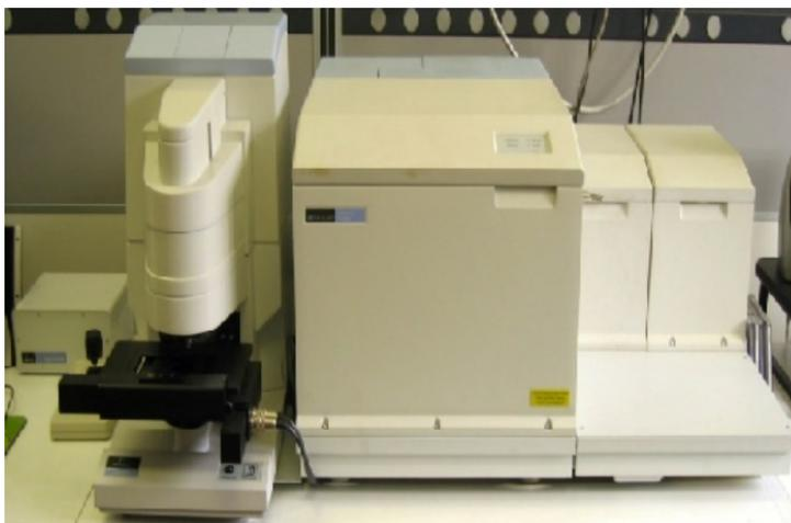
*Figura 17 - Spettrometro FT-IR*
