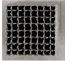
Figura 3.5 – Struttura Block Support
