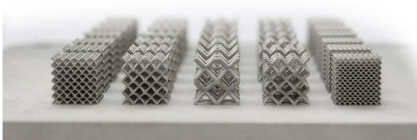
2.3 – Tipiche strutture lattice
