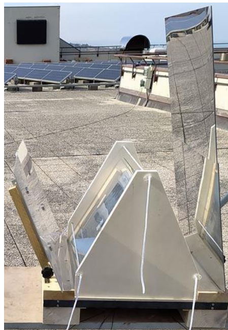
Fig. 30: Prima configurazione del Newton Solar Dryer
