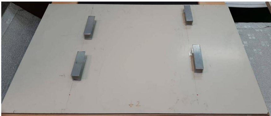
Fig. 33: Sistema a slitta nella parte posteriore degli specchi più grandi
