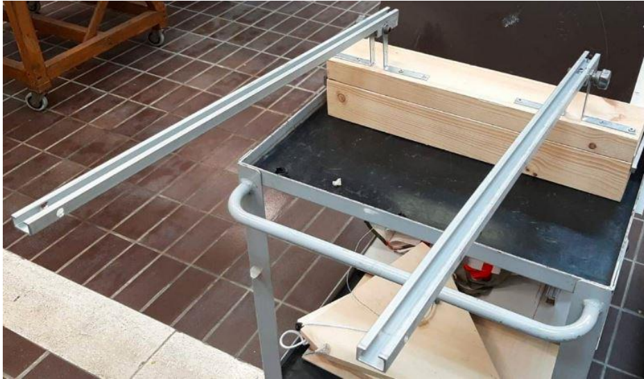
Fig. 32: Bracci di sostegno per gli specchi più grandi
