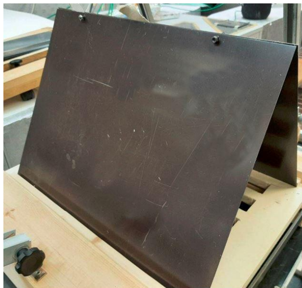
Fig. 26: Lastre di acciaio zincate e preverniciate con bulloni di bloccaggio posizionate sulla base
