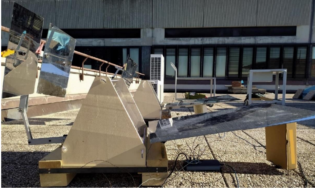
Fig. 31: Vista della configurazione finale del Newton Solar Dryer durante il funzionamento
