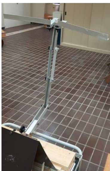
Fig. 35: Nuovo sostegno con bracci regolabili per gli specchi
