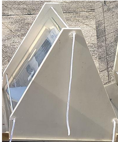
Fig. 28: Sportelli laterali con sistema di tensionamento durante il funzionamento dell'essiccatore
