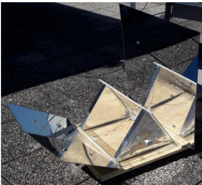
Fig. 29: Configurazione a 4 specchi del Newton Solar Oven
