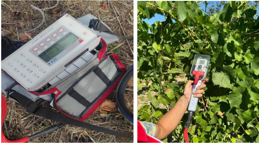
Figura 1.2.1-1 LCA-3 gas analyser open system portatile, analizzatore di gas ad infrarosso (ADC) e camera fogliare Parkinson
