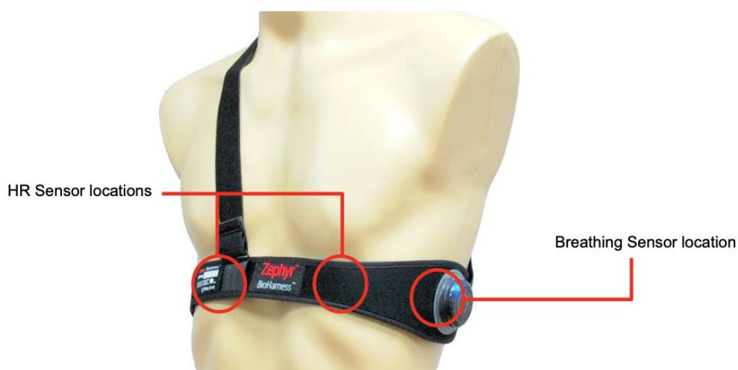
Figura 22: Posizionamento del sensore
