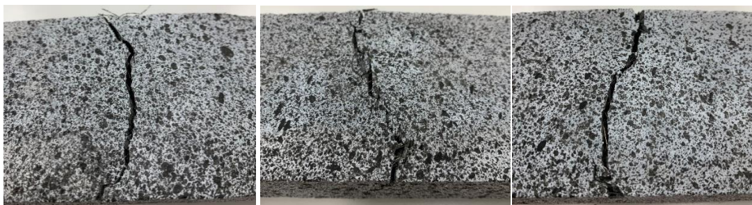
Figura 55: Partendo da sinistra troviamo le immagini della fessura principale nei provini UHPFRC_200_D, E, F.
