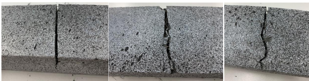
Figura 49: Partendo da sinistra troviamo le immagini della fessura principale nei provini UHPFRC_100_D, E, F.
