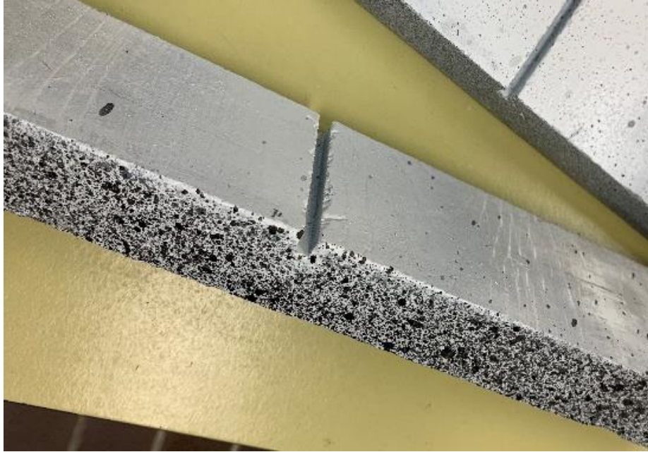
Figura 17: Due provini con intaglio dopo la verniciatura, è possibile notare il pattern irregolare e ad alto contrasto cromatico nell'altezza del provino dove saranno puntate le fotocamere.
