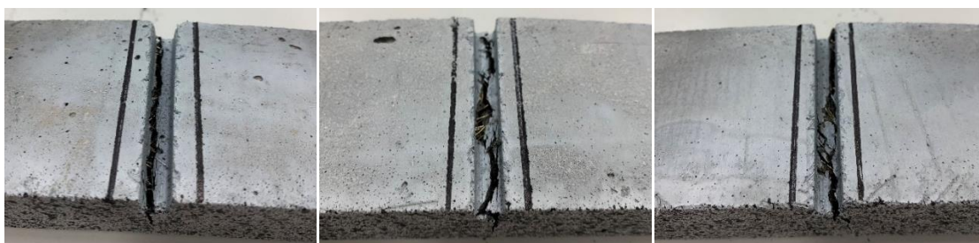
Figura 40: Partendo da sinistra troviamo le immagini della fessura principale nei provini UHPFRC_150_INT_A, B, C.
