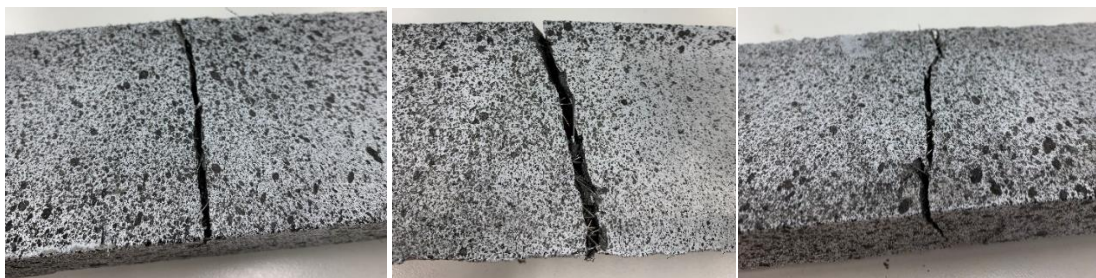
Figura 52: Partendo da sinistra troviamo le immagini della fessura principale nei provini UHPFRC_150_D, E, F
