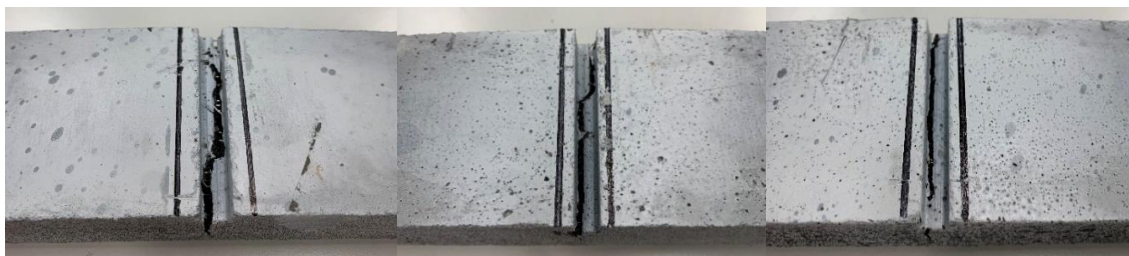
Figura 34: Partendo da sinistra troviamo le immagini della fessura principale nei provini UHPFRC_50_INT_A, B, C.
