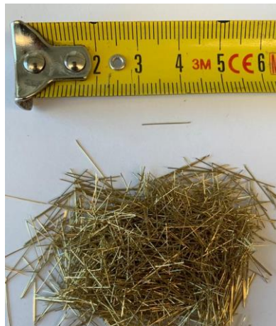
Figura 27: Fibre in acciaio GOLD micro.
