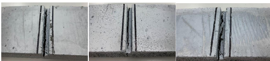
Figura 37: Partendo da sinistra troviamo le immagini della fessura principale nei provini UHPFRC_100_INT_A, B, C.
