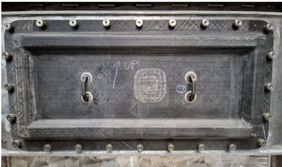
Figura 38: Corazza montata sul Mock Up
