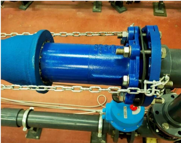
Figura 12 a. Collegamento con tazza flangiata a monte
