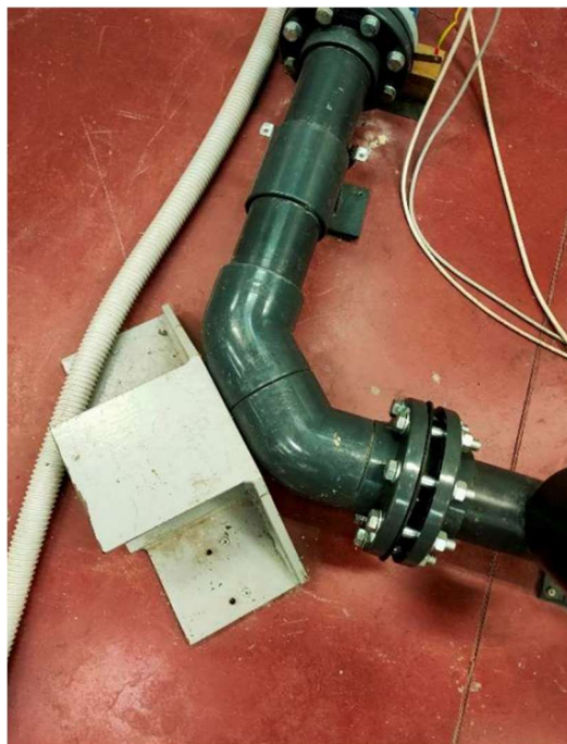
Figura 11. Curve di 45° unite con fissato il blocco di ancoraggio.
