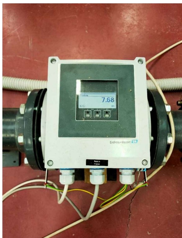
Figura 20 a. Misuratore di portata di monte (Promag 10D80) Figura 20 b. Misuratore di portata di valle (Promag 400)
