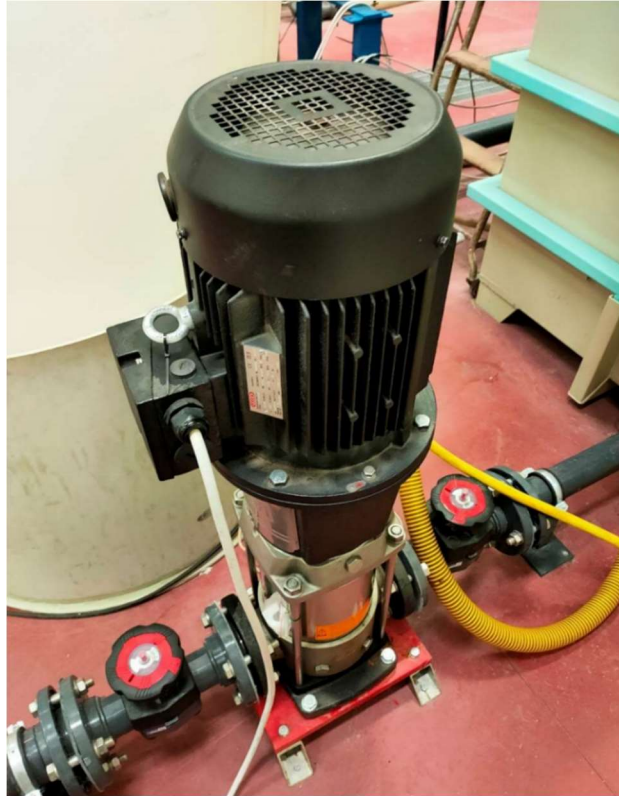
Figura 8. Elettropompa verticale multistadio con valvole a membrana.
