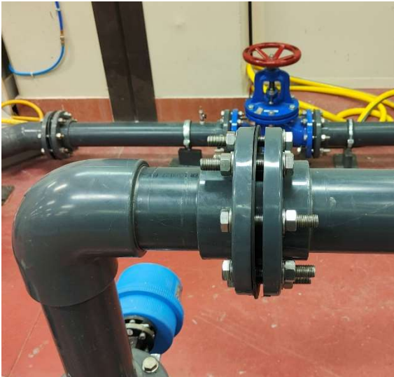
Figura 13 a. Sbocco flangiato a valle
