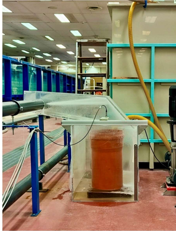
Figura 22. Serbatoio di raccolta con protezione in plexiglass
