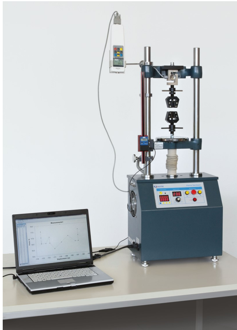
Figura 21: dinamometro per prova a trazione e computer per rappresentare il diagramma forza/allungamento
