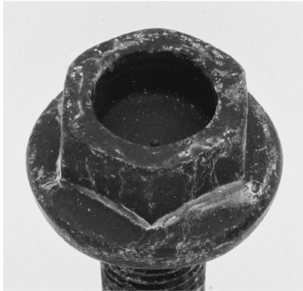
Figura 17: massimo grado di corrosione ammesso dopo 120 ore in nebbia salina
