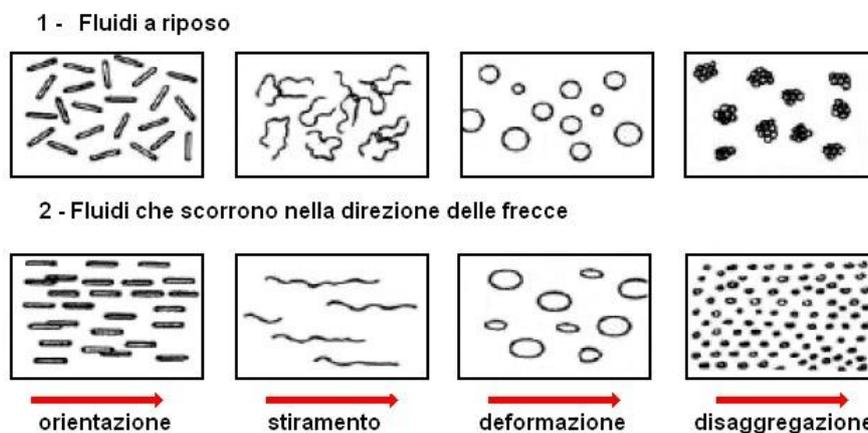
Figura 8. *Comportamento delle catene polimeriche soggette ad uno sforzo (Guidotti, 2003)*
