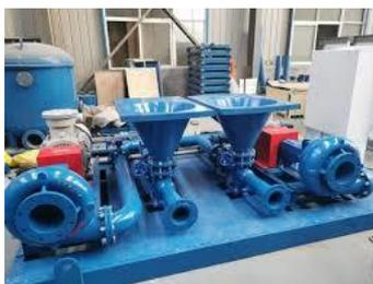
Figura 13. *La tramoggia Venturi* ([www.formedil.it](http://www.formedil.it), 2012)
