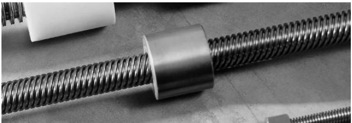
Fig. 5.1: Vite a profilo trapezoidale con madrevite. In questa immagine la madrevite ruota mentre la vite scorre su di essa in quanto la sua rotazione viene impedita. [Immagine presa da catalogo Thomson linear]
