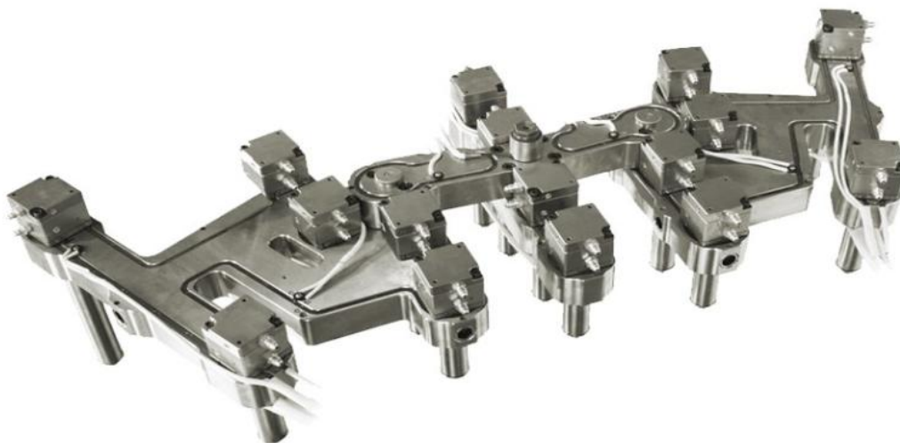
Fig. 4.2: Camera calda con otturatori attuati tramite cilindri oleodinamici, fissati direttamente sul manifold. [Immagine presa da sito iHR]
