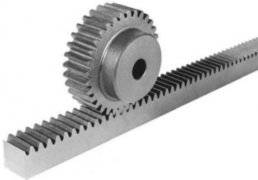
Fig. 5.3: Immagine di una cremagliera. Ipotizzando che la coppia sia applicata al pignone, e che sia fissato, la dentiera al di sotto trasla.
