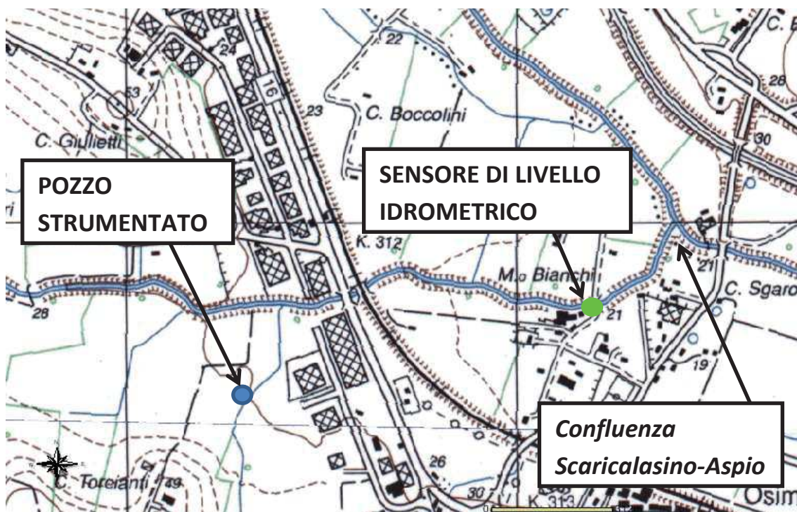
Fig. 4. 81 – ubicazione pozzo strumentato “POZZO A” (blu) e sensore per la registrazione in continuo dei livelli idrometrici (verde) su ingrandimento carta IGM scala 1:25000
