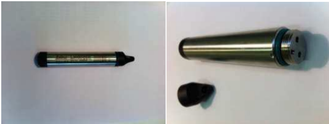
Fig. 4. 16 – sensore per la misura in continuo dell'altezza idrometrica
