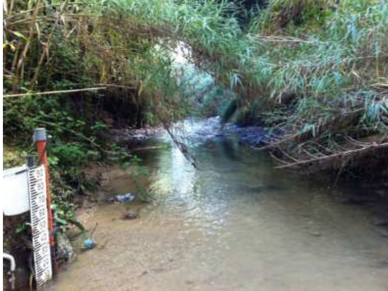
Fig. 4. 15 – asta idrometrica alla stazione di misura sul Rio Scaricalasino
