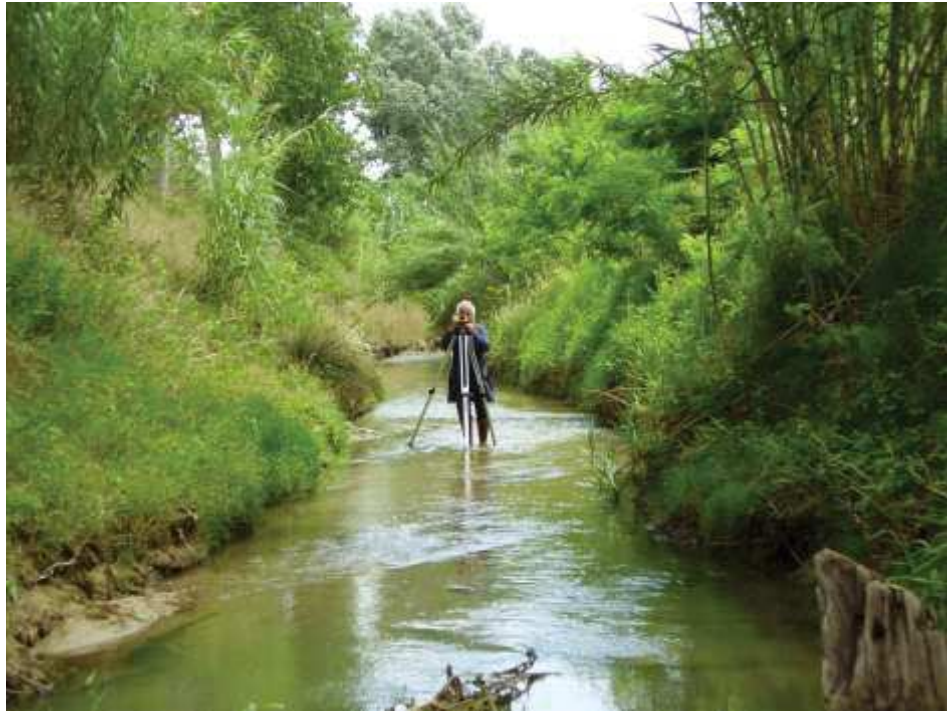
Fig. 4. 86 – lettura eseguita mediante livello
