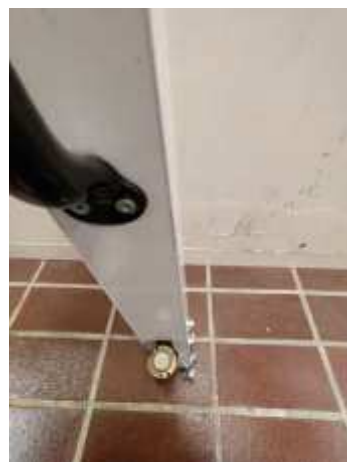
Fig. 4. 11 – particolare della bolla di cui è dotata la stadia
