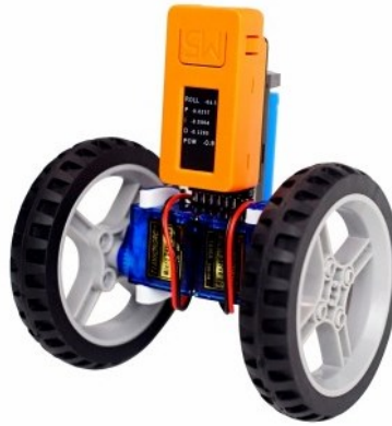
Figura 19: M5StickC [4] con DIY KIT BalaC ([12] DIY KIT BalaC, s.d.)
