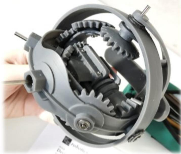
**Figura 8.** copia fisica giunto universale riconfigurabile
