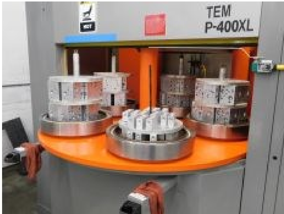
Figura 3.2.2. Caricamento dei pezzi nella piattaforma
