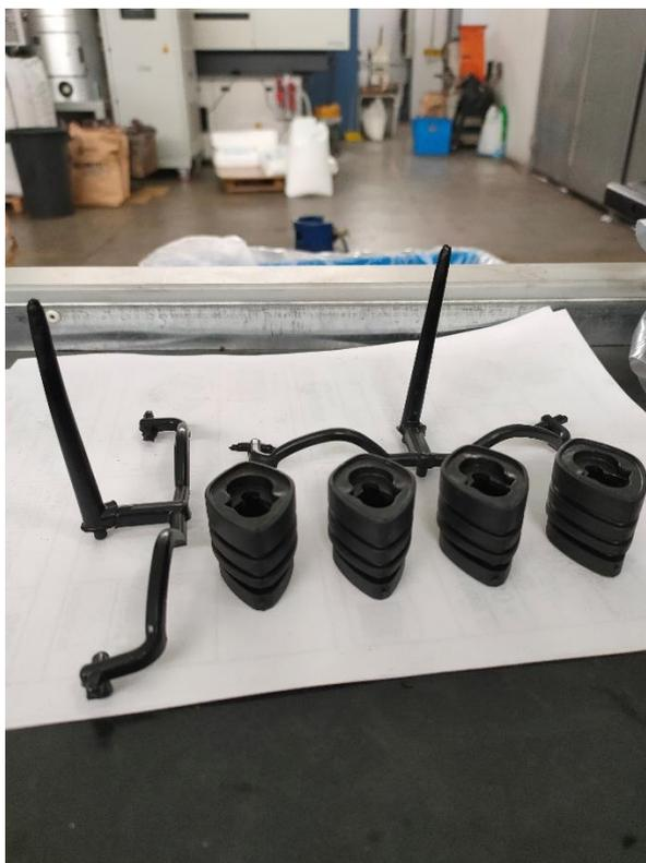
Esso è costituito da un particolare elastomero termoplastico poliuretano detto anche **TPU**, è un materiale altamente resistente all'usura, all'abrasione, allo strappo e alla lacerazione, che ha inoltre una grande capacità di ammortizzare gli urti e è molto flessibile anche a basse temperature.
