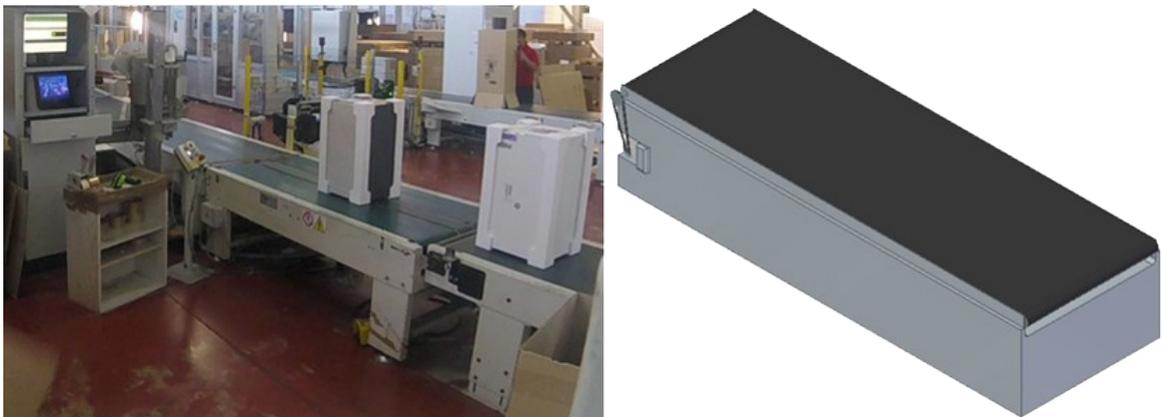
Figura 26 - Nastro trasportatore pensili reale (Sx) nastro trasportatore utilizzato per simulazione (Dx)
