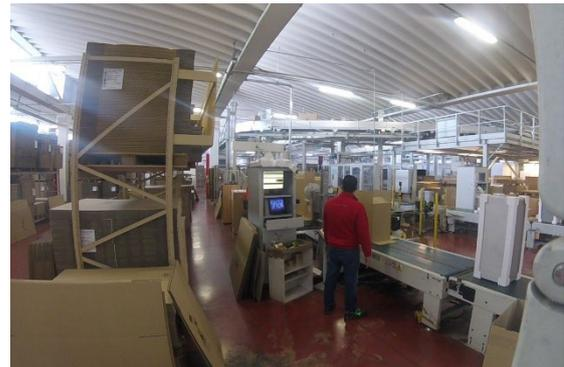
Figura 9 - Panoramica della postazione di inserimento angolari(Sx) e postazione di inserimento scatole (Dx)
