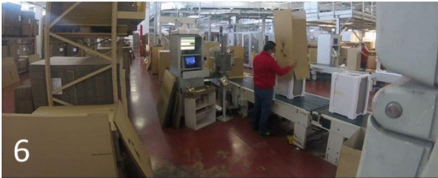
Figura 15 - L'operatore Inserisce la scatola sul pensile
