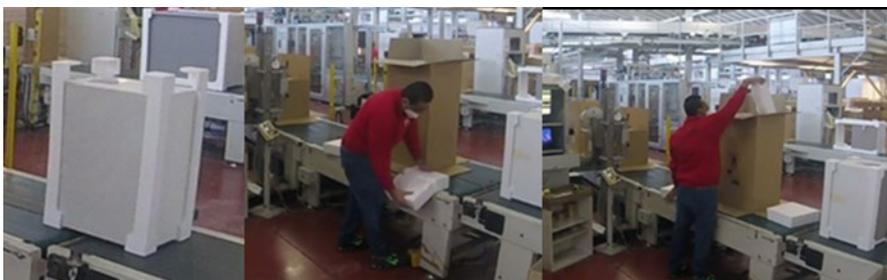
Figura 16 - Procedimento per imballare pensili con lato più corto dell'angolare. A sinistra: Angolare maggiore del pensile; al centro: preparazione del polistirolo; a destra: L'operatore inserisce il polistirolo all'interno della scatola
