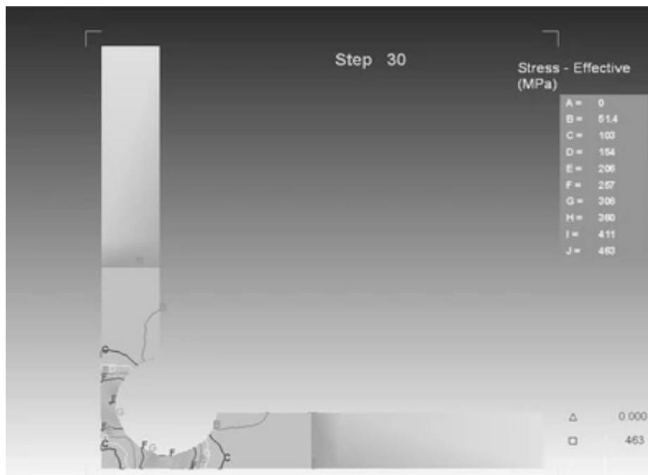
Figura 15. Primo step di un generico processo di ottimizzazione della geometria del provino
