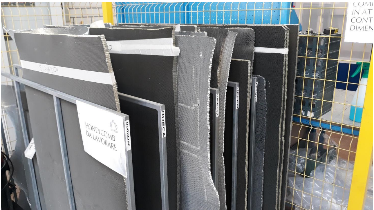
(fig. 5.2 fogli di honeycomb in alluminio)
