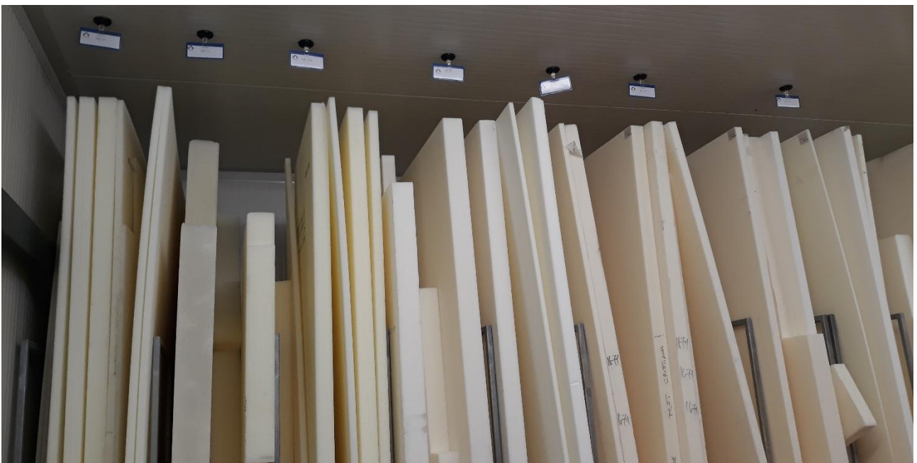
(fig. 5.3 schiume di rohacell)
