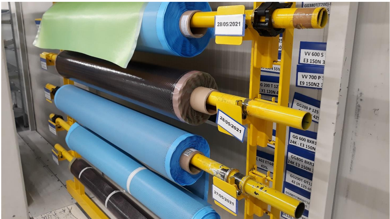
(fig. 4.2 controllo data di scongelamento dei prepreg tramite etichette)
