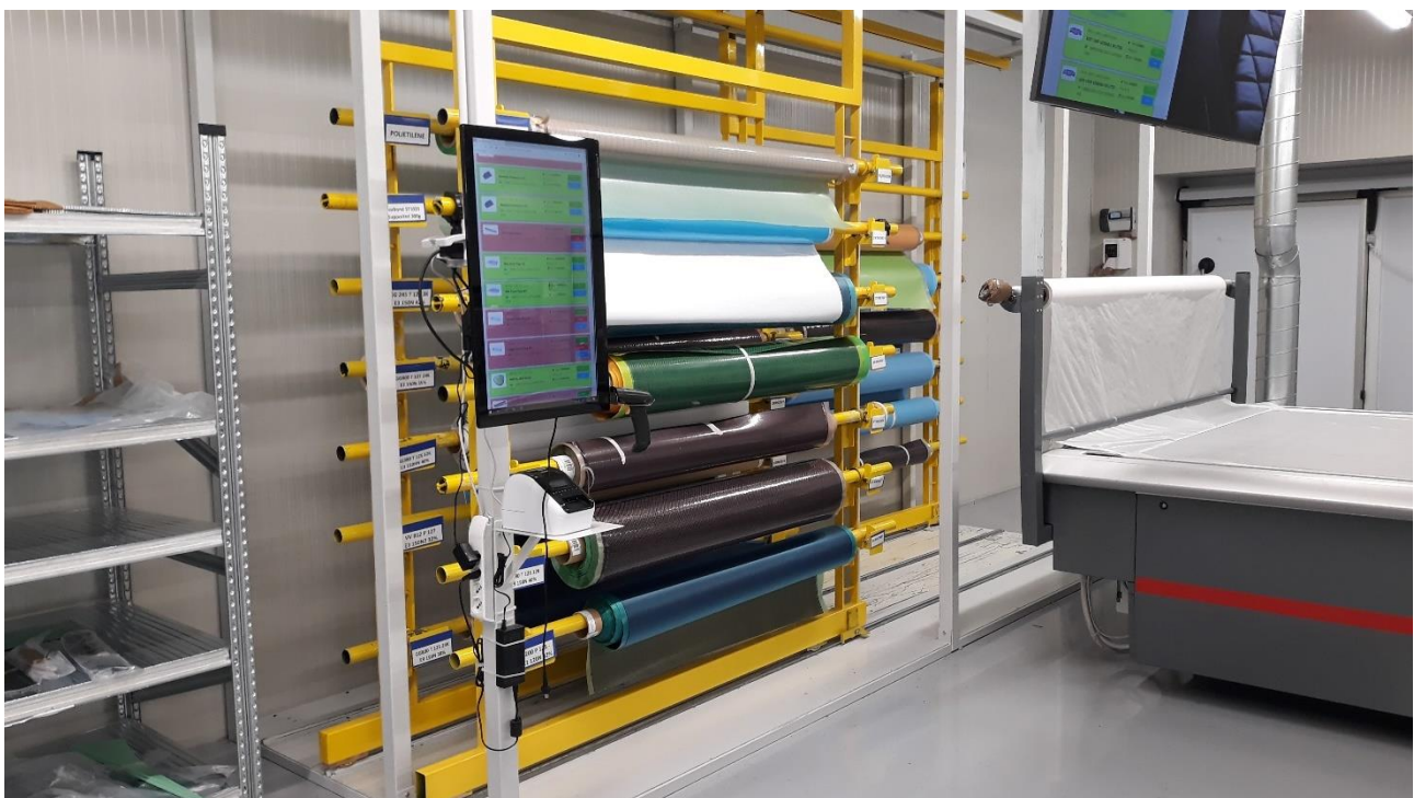
(fig. 4.1 rastrelliera su cui vengono conservati i rotoli di prepreg)
