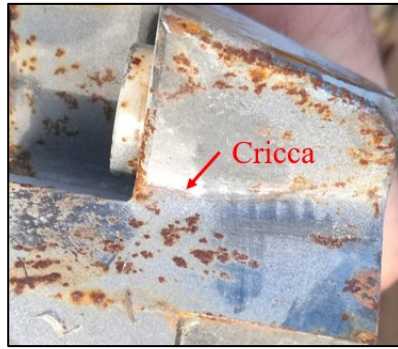
Figura 2.2 – Cricca sul bilanciante [2]
