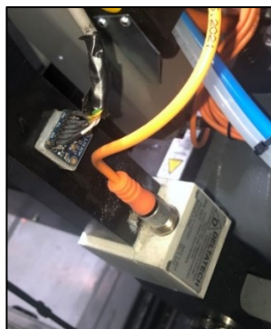
Figura 3.1 – Accelerometro ed estensimetro posti sulla biella
