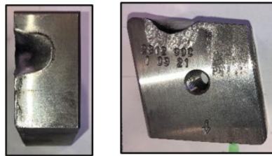
Figura 3.7 – Coltello C45 con usura in seguito a 3000 tagli
