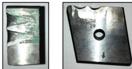
Figura 3.5 – Coltello Unimax con una doppia usura realizzata manualmente
