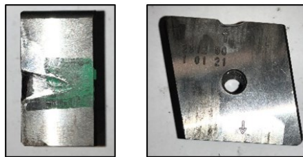
Figura 3.4 – Coltello Unimax con una singola usura realizzata manualmente
