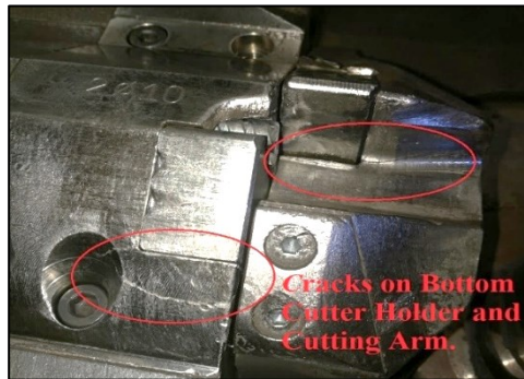
Figura 2.3 – Cricche sulla scatola guidafile e sul bilanciante [2]
