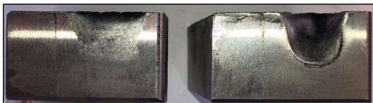
Figura 5.31 – Confronto fra usura Hardox (a sinistra) e usura C45 (a destra), viste dal basso
