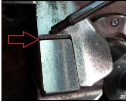
Figura 2.4 – Deformazione nella zona superiore [2]
