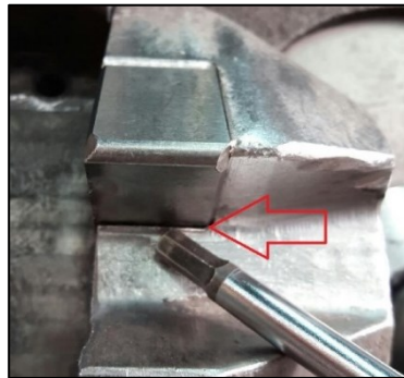
Figura 2.5 – Deformazione nella zona inferiore [2]
