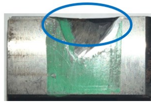
Figura 5.9 – Usura completa realizzata manualmente
