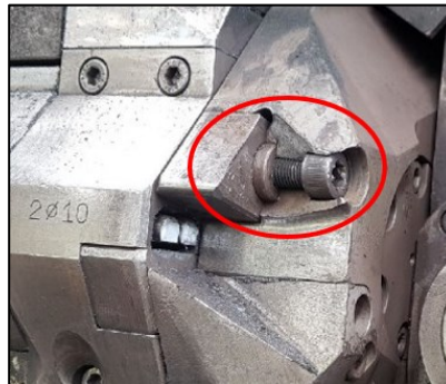
Figura 2.1 – Rottura del bilanciante [2]
