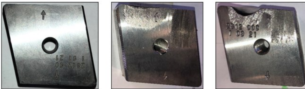
Figura 5.1 – Esempi di coltello nuovo, coltello semi-usurato, coltello usurato
