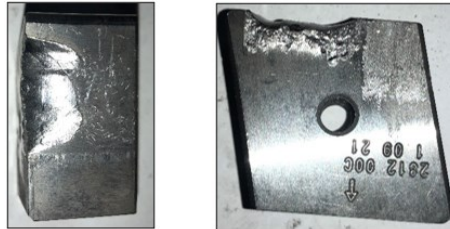
Figura 2.8 – Coltello in presenza di degrado
