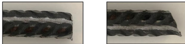
Figura 2.6 – Differenza tra tondino tagliato correttamente e in modo errato
