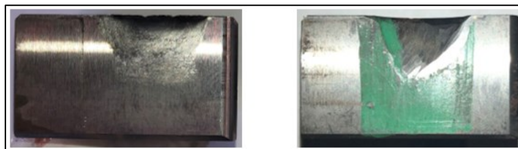
Figura 5.33 – Confronto tra usura Hardox (a sinistra) e usura completa realizzata manualmente (a destra)
