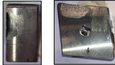
Figura 3.8 – Coltello Hardox con usura in seguito a 18000 tagli
