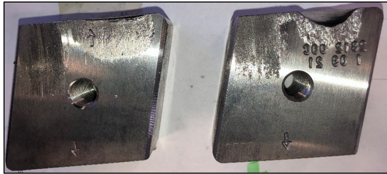
Figura 5.32 – Confronto fra usura Hardox a (sinistra) e usura C45 a (destra), viste di lato
