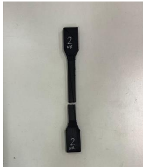
Figura 24. Rottura provino nr2 in seguito al test di trazione.
