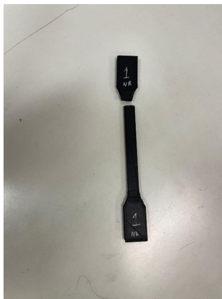
Figura 20. Rottura provino nr1 in seguito al test di trazione.
