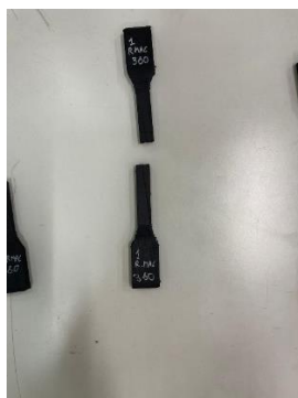
Figura 32. Rottura provino ricmac1 in seguito al test di trazione.
