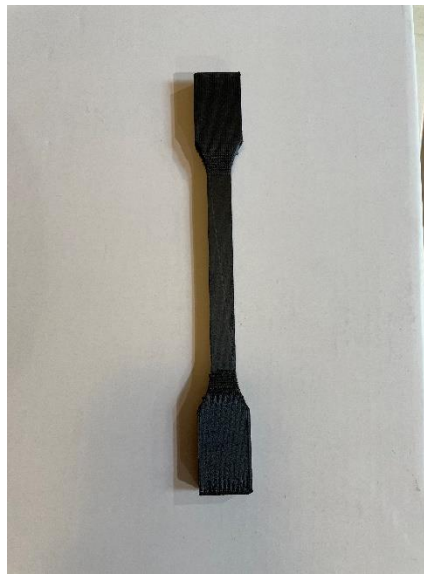
Figura 6. Provino in carbon-peek con forma “a osso di cane”.
