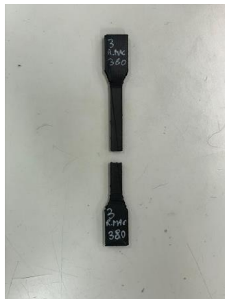
Figura 40. Rottura provino ricmac3 in seguito al test di trazione
