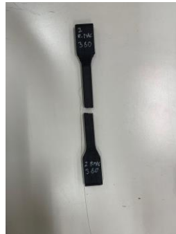
Figura 36. Rottura provino ricmac2 in seguito al test di trazione
