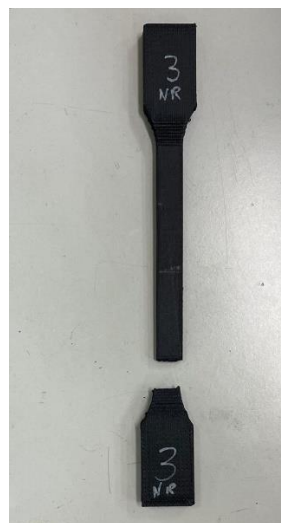
Figura 52. Rottura provino ricorno3 in seguito al test di trazione
