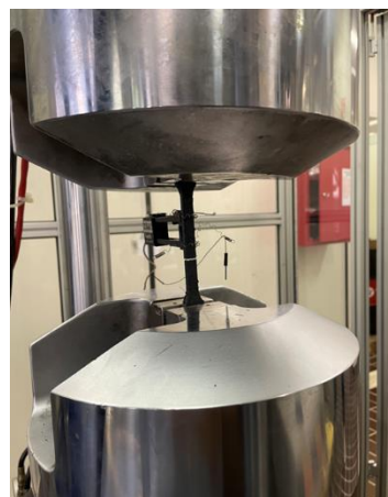
Figura 15. Provino durante il test di trazione; al centro si può notare il punto di rottura.
