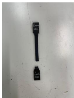
Figura 48. Rottura provino ricorno2 in seguito al test di trazione
