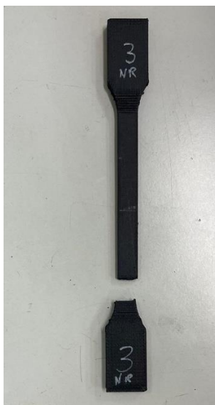
Figura 28. Rottura provino nr1 in seguito al test di trazione.
