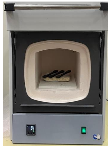
Figura 11. Ricottura di 3 provini in forno a 200°C.
