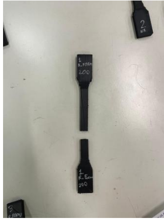
Figura 44. Rottura provino ricforno1 in seguito al test di trazione
