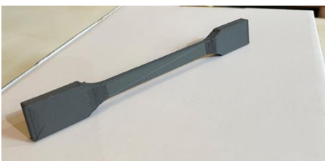
Figura 3. Provino per test di trazione carbon-PEEK
