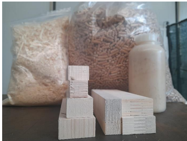
Figura 3-1: campioni analizzati in laboratorio. Sullo sfondo da sinistra troviamo trucioli, pellet e colla. In primo piano il dettaglio dei listelli di legno vergine, mentre a destra si osserva il dettaglio del finger joint.
