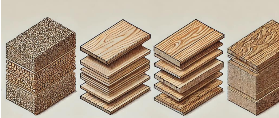
Figura 3-8: Esempio di pannelli. Da sinistra verso destra abbiamo truciolare, multistrato e OSB.
