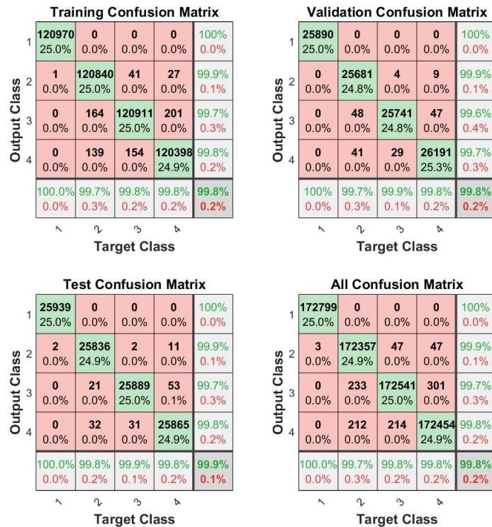
Figura 75: Matrice di confusione della rete neurale per il riconoscimento del carico elettrico
