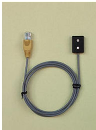
*Figura 2.8. Sonde a geometria fissa*
