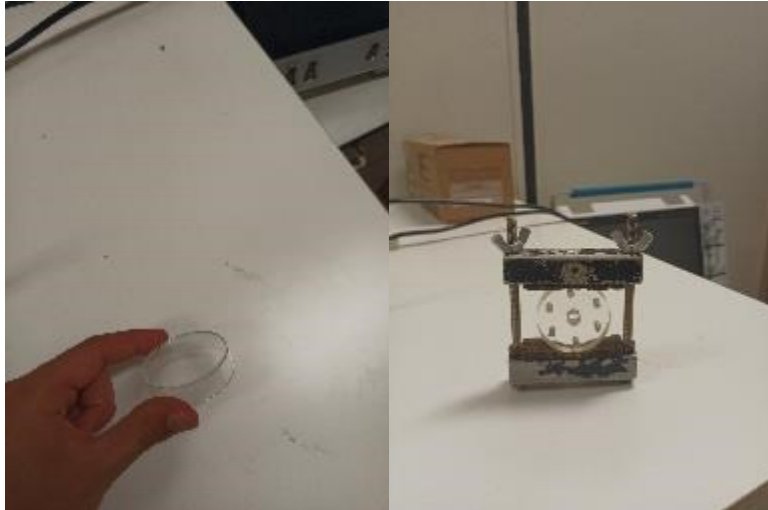
Figura 2. 6 Campioni di riferimento per il set-up del banco: a) disco di Petri, b) flangia forata
