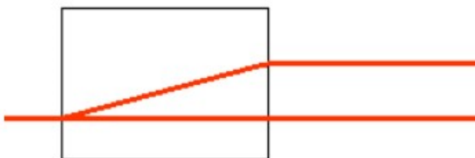
Figura 1. 7 Schematizzazione del fenomeno della birifrangenza ottica
