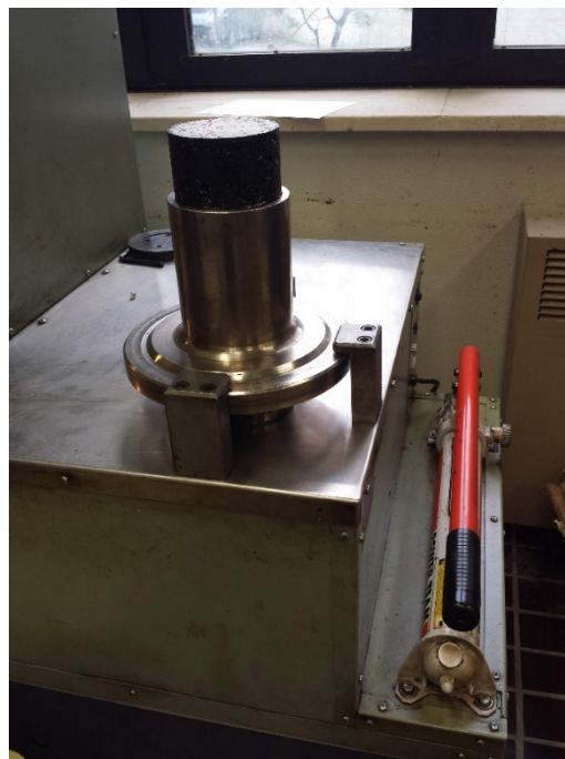
Figura 3.16: Operazione di rimozione del provino mediante martinetto idraulico
