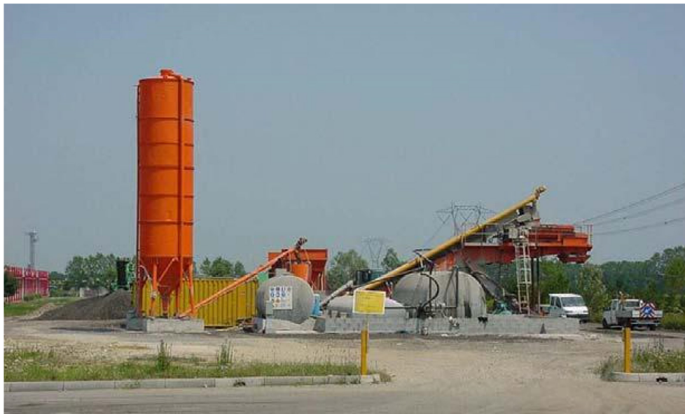
Figura 1.4: impianto fisso di riciclaggio a freddo
