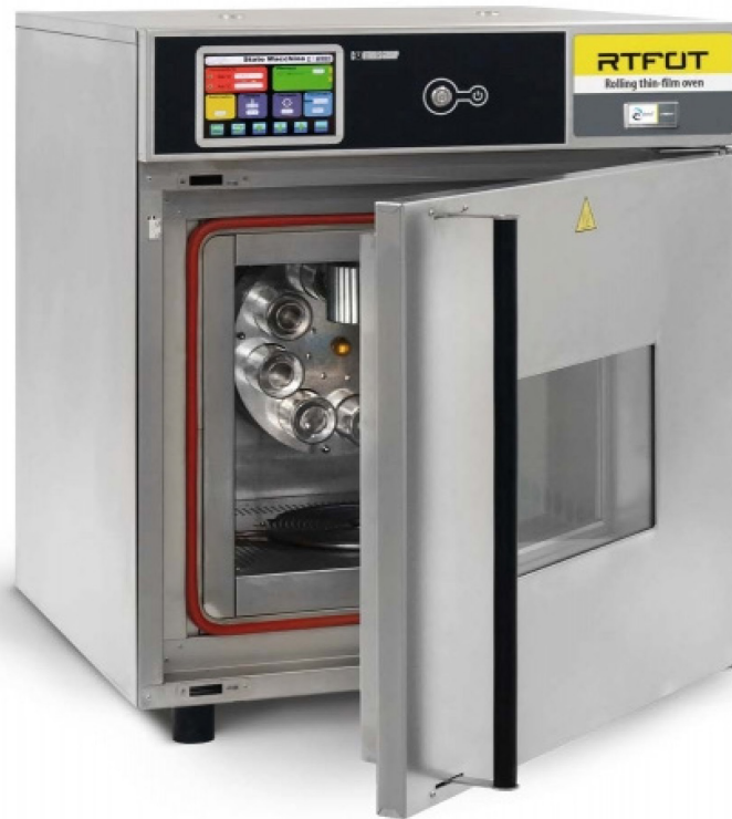
Figura 1.17: Dispositivo utilizzato per la prova RTFOT
