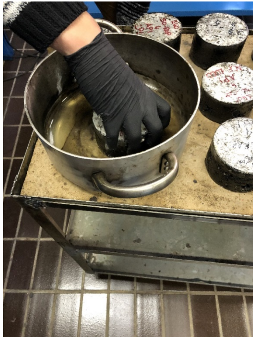
Figura 3.23: Immersione del provino all'interno della paraffina sciolta per sigillare i fori
