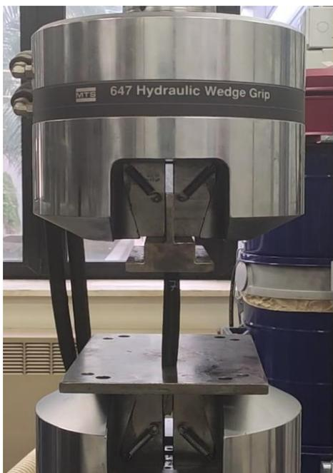
*Figura 4.1 Provino posizionato sulla macchina prima dell'applicazione del carico.*
