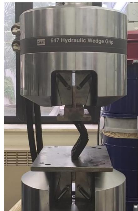
*Figura 4.2 Provino giunto a rottura dopo l'applicazione del carico.*
