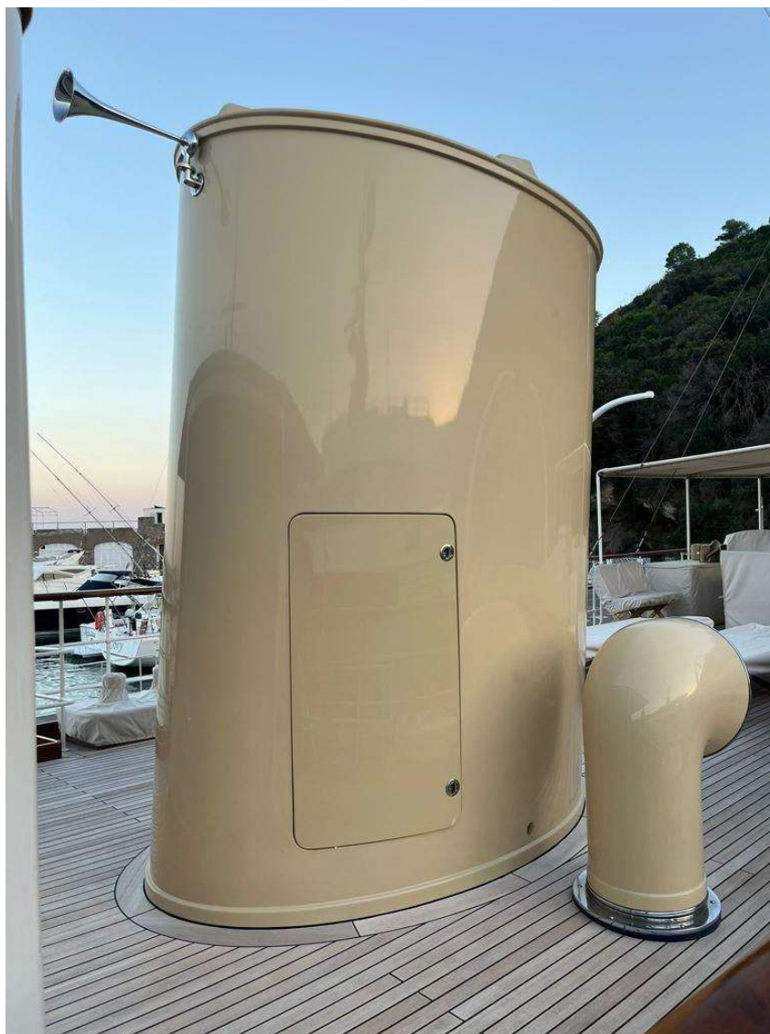
Figura 12: Fumaiolo riutilizzato come box antenne
