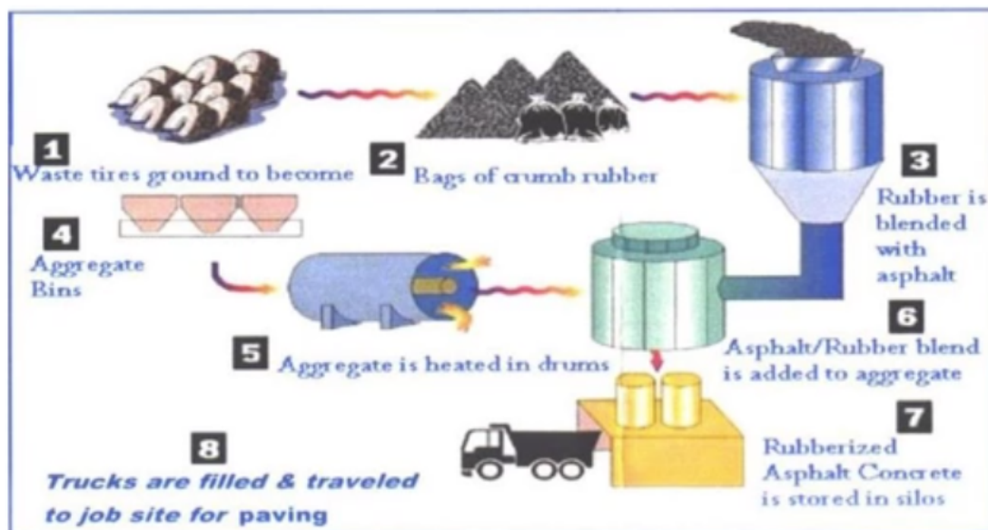
Figura 17: Processo di produzione bitume modificato
