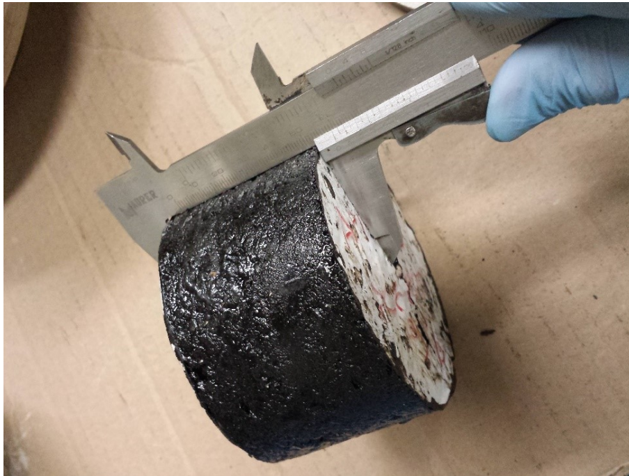
Figura 61: determinazione altezza media del provino tramite calibro
