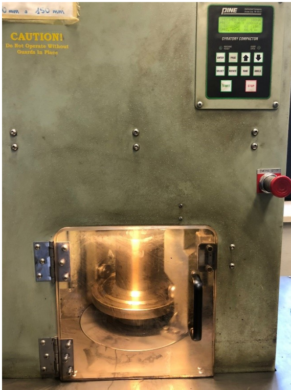
Figura 51: compattazione in opera
