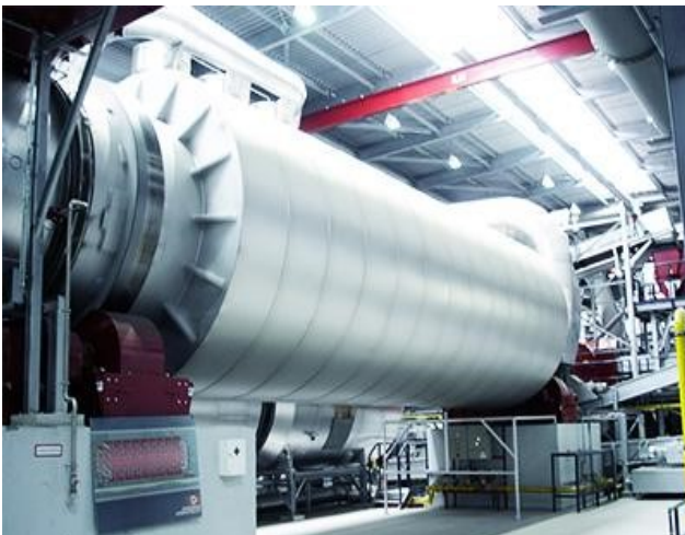
Figura 23: Tamburo essiccatore parte esterna
