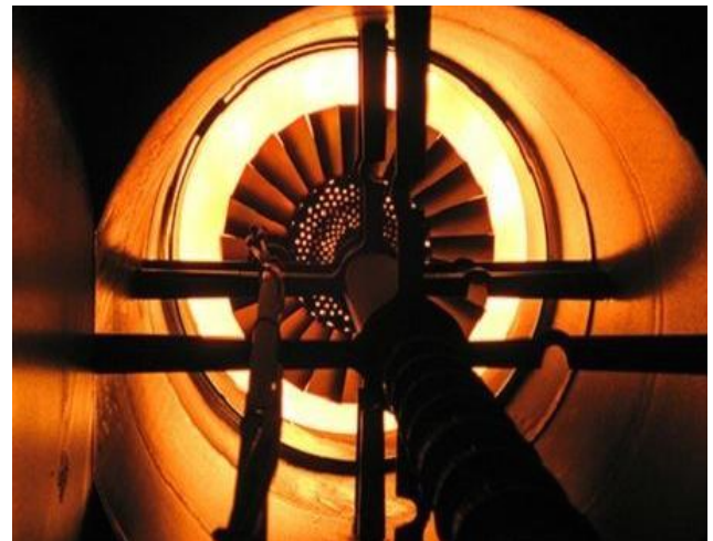
Figura 24: Tamburo essiccatore parte interna
