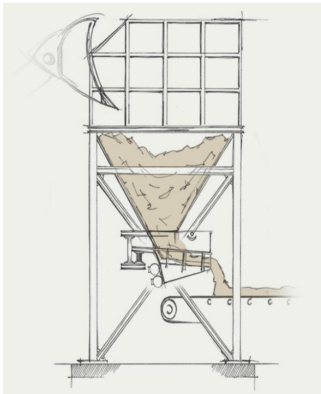
Figura 22: Tramogge per la separazione degli aggregati
