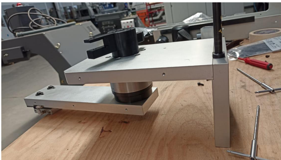
Figura 44 Assemblaggio componenti meccaniche del braccio pneumatico
