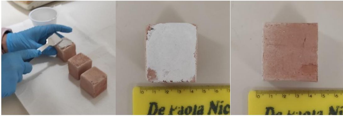
Figura 37 Stesura di uno strato gesso sui provini per conferire planarità
