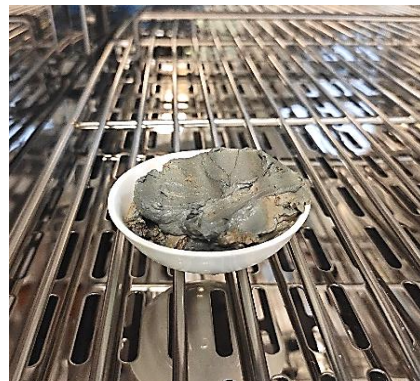
Figura 17 Campione DS2 essiccato in stufa
