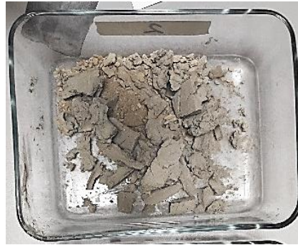
Figura 14 Campione DS1 essiccato all'aria
