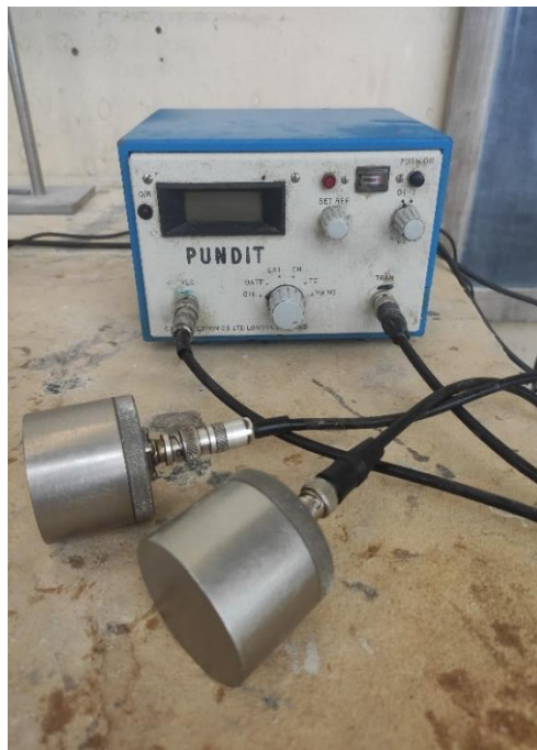
Figura 30 Strumento Pundit per prova ad ultrasuoni
