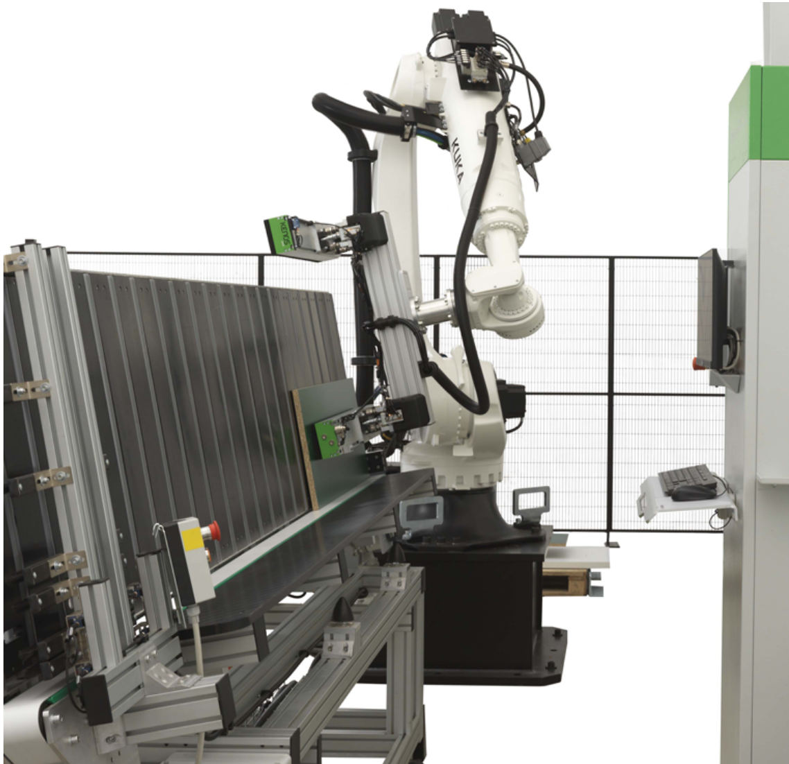
Figura 2.1 - Una delle prime versioni di Robot Kuka equipaggiato con Kenos KVG durante l'operazione di inserimento del pannello sullo squadro
