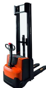
Figura 21: Esempio transpallet elevatore
