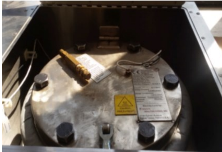
Figura 2.16 Chiusura del coperchio della camera principale del PAV
