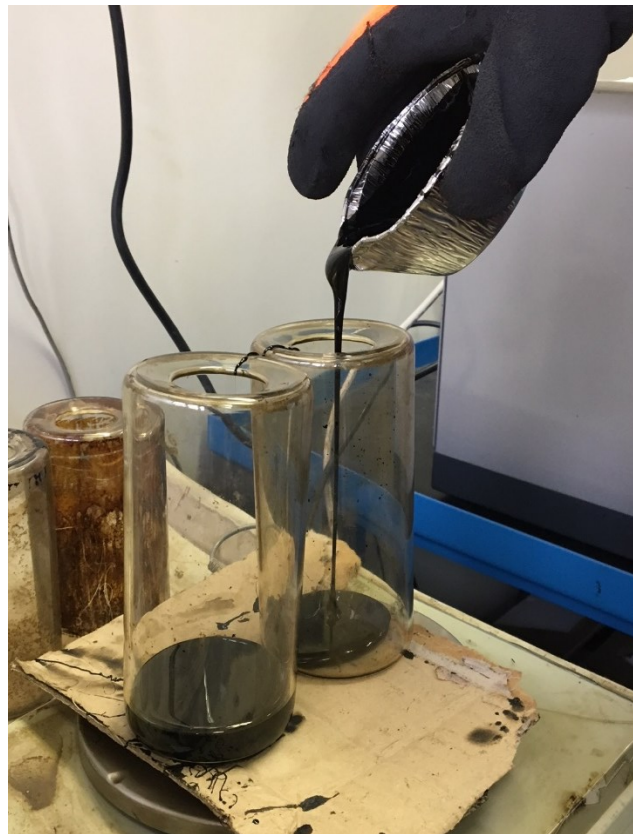
Figura 2.11 Cilindri di vetro utilizzati per invecchiamento a breve termine RTFOT, prima dell'invecchiamento
