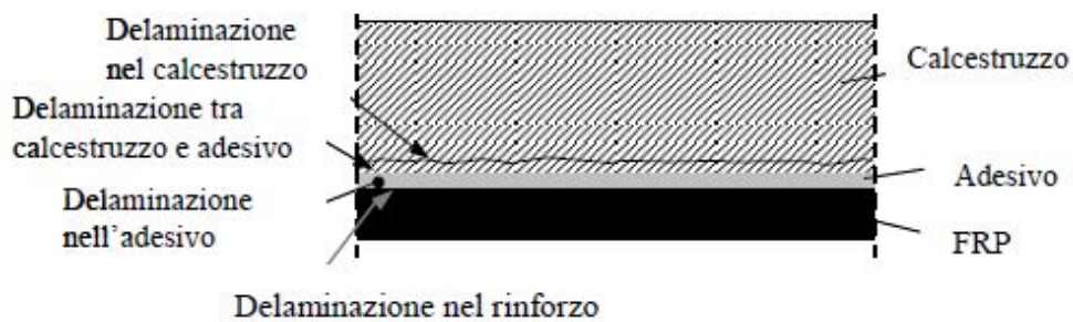
Figura4.1- Perdita di aderenza rinforzo-calcestruzzo
