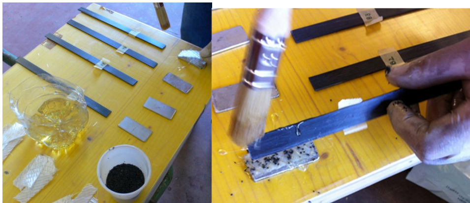
Figure 2.9-Applicazione dei talloni (provini di tipo L)
