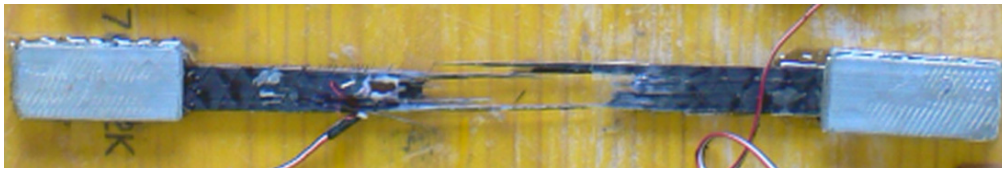
Figure 2.20- Rottura nei provini di tipo TC (tessuti in CFRP)-classificazione: SGM (Long Gage Middle)
