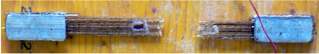
Figure 2.23- Rottura nei provini di tipo TA (tessuti in fili di acciaio) - classificazione: LGM (Lateral Splitting Gage Middle)
