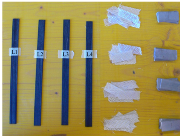
Figura 2.8-Realizzazione campioni di tipo L (materiali)
