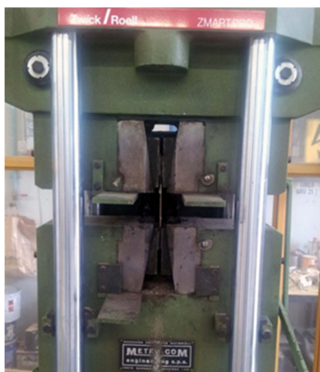
Figura 2.15- Provino in tessuto sotto carico
