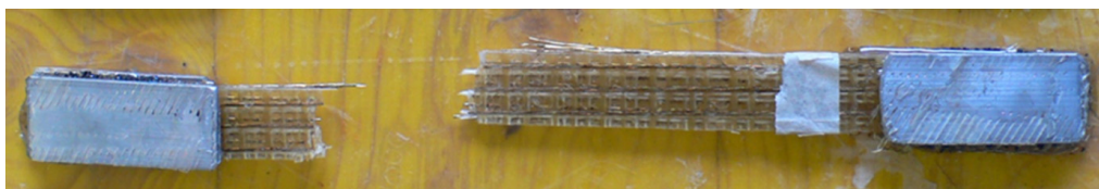
Figure 2.22- Rottura nei provini di tipo TB (tessuti in fibra di basalto) - classificazione: SGM (Longe Splitting Gage Middle)
