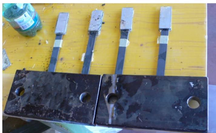
Figura 2.10-Maturazione e asciugatura (provino di tipo L)
