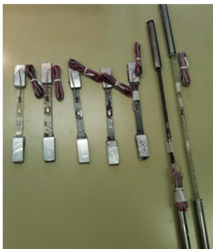
Figura 2.16- Applicazione degli estensimetri ai provini
