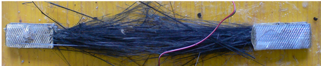
Figura 2.19-Rottura nei provini di tipo L (laminati in CFRP) -classificazione: XGM (Explosive Gage Middle)
