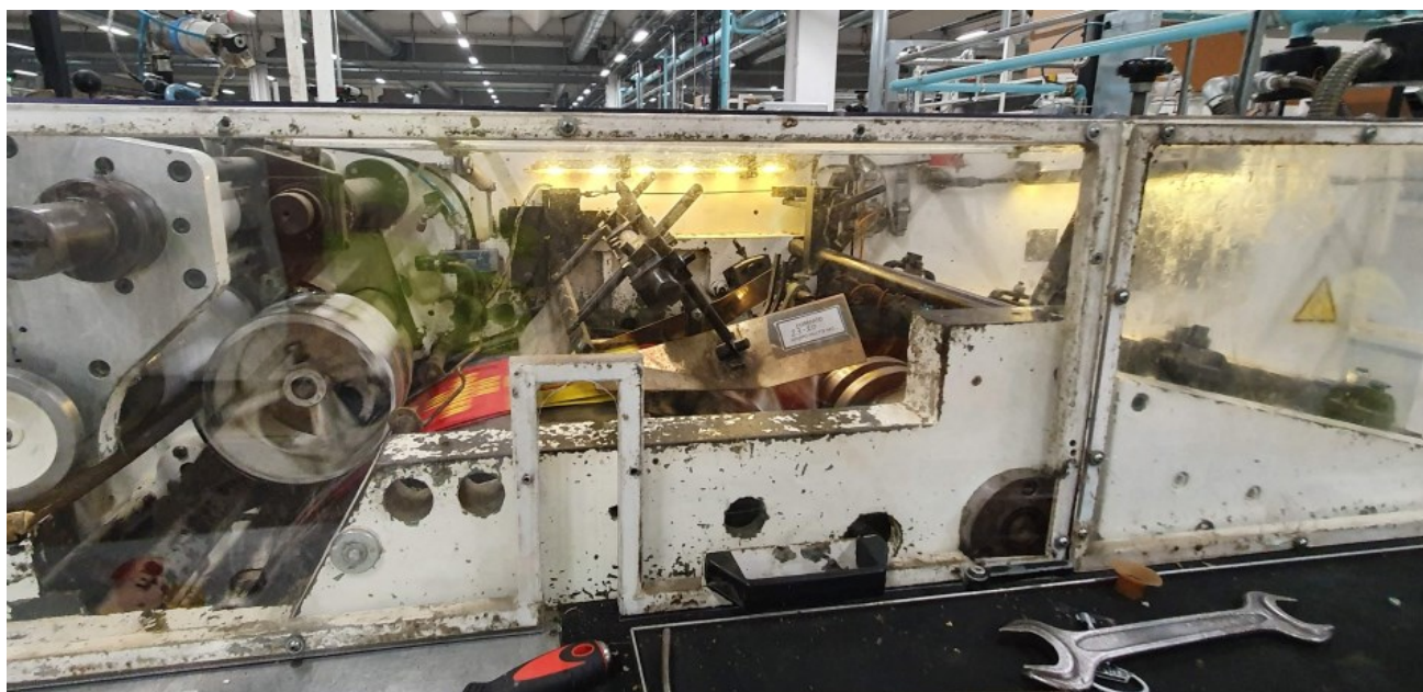
Figura 4-3 Palette all'interno della macchina
