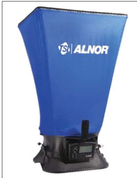
Figura 3.3 – Foto del balometro utilizzato (ALNOR EBT721)
