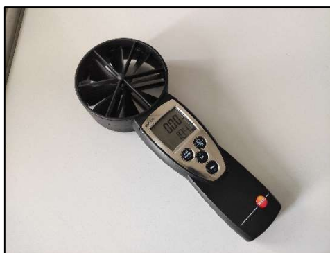
Figura 3.2 – Foto dell'anemometro utilizzato (TESTO 417)
