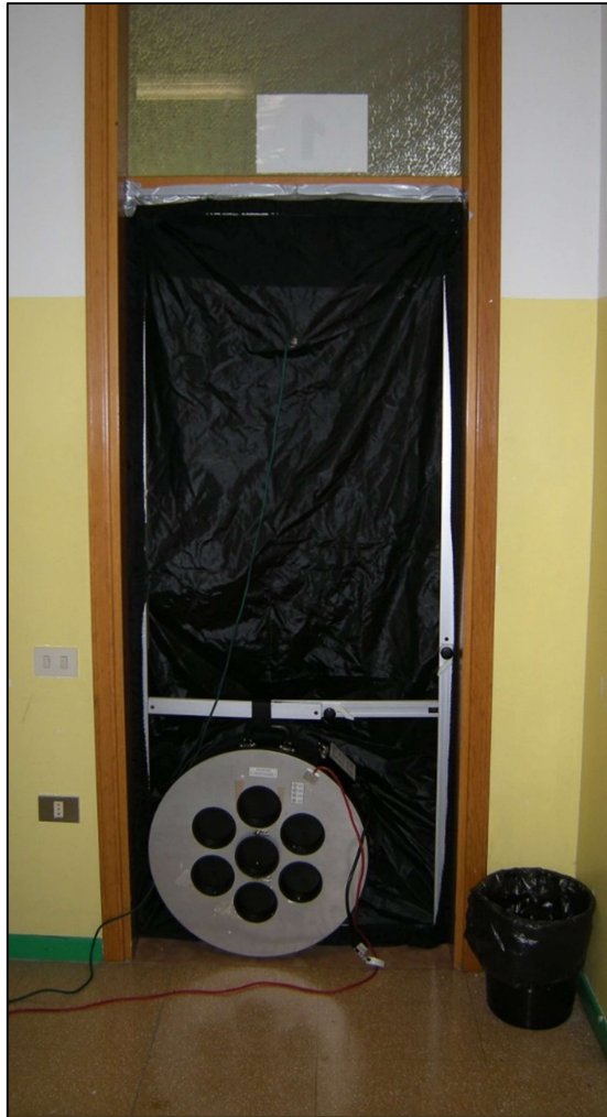
Figura 3.6 - Foto strumenti utilizzati (Infiltec E3 Blower Door)
