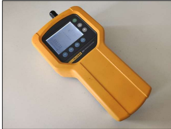
Figura 3.4 - Foto del conta-particelle utilizzato (Fluke 983)
