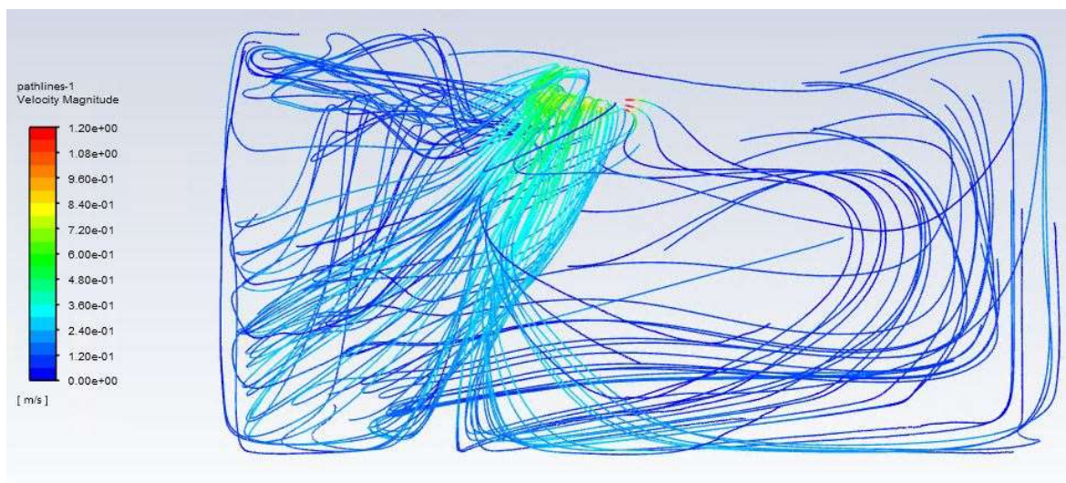
Figura 4.55 – Pathline di velocità dell'aria – vista frontale
