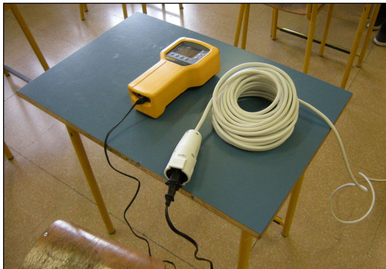
Figura 3.17 – Foto installazione conta-particelle
