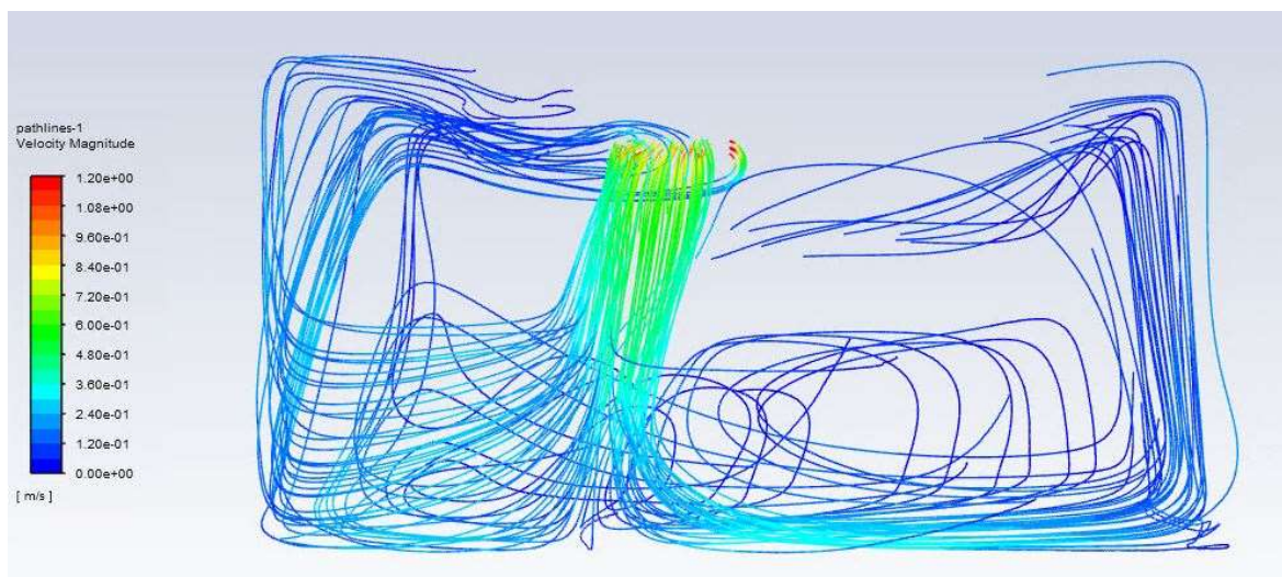
Figura 4.85 – Pathline di velocità dell'aria – vista frontale
