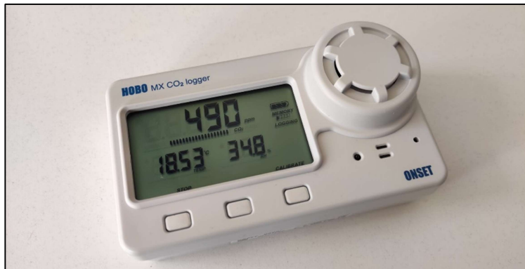
Figura 3.1 – Foto dell'acquisitore utilizzato (HOBO MX CO 2 Logger)
