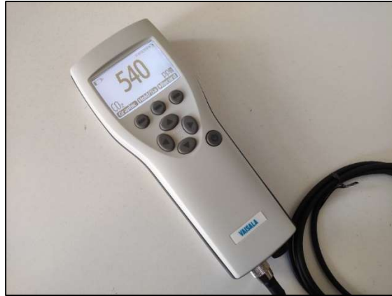
Figura 3.7 - Foto del sensore utilizzato (Vaisala HM 70)
