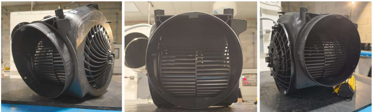
Figura 5.127: Stampa 3D dell'ETB 140 senza setto
