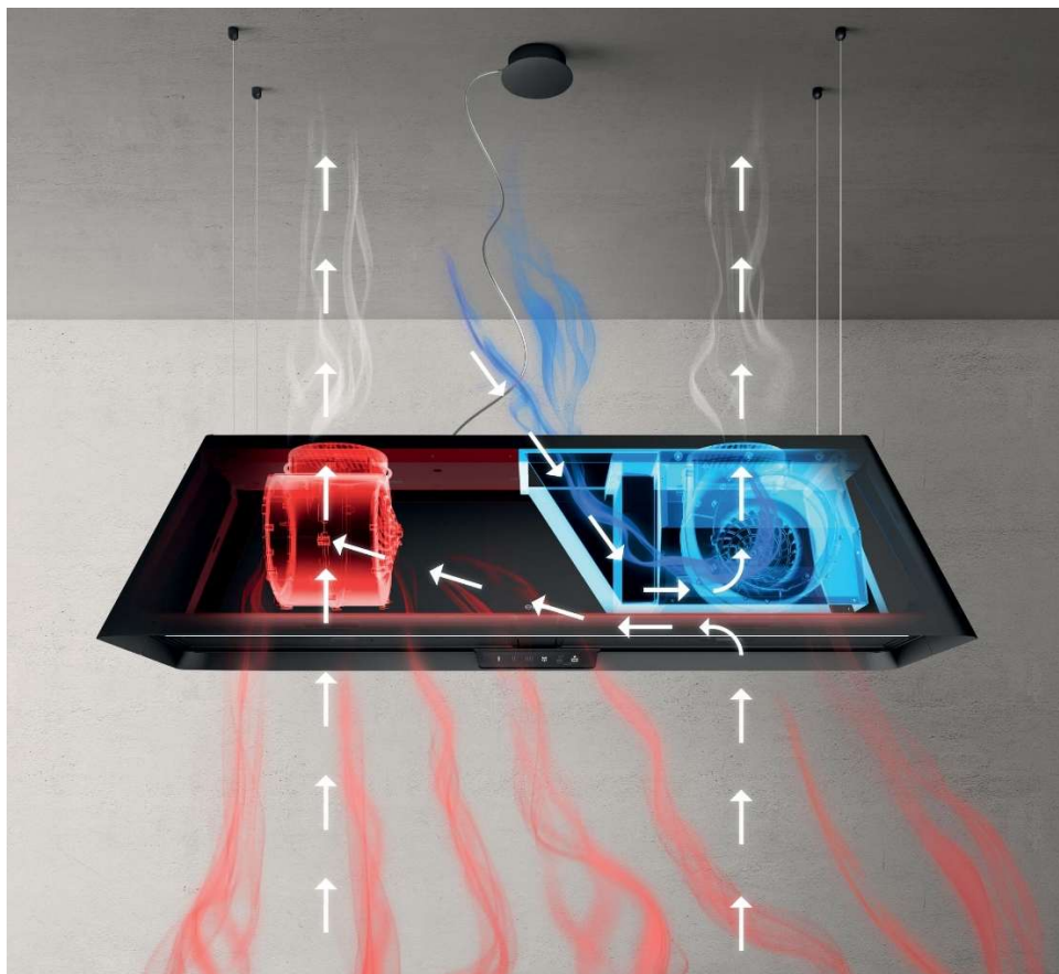
Figura 1.6: Differenza tra cappa aspirante (a destra) e cappa filtrante (a sinistra)
