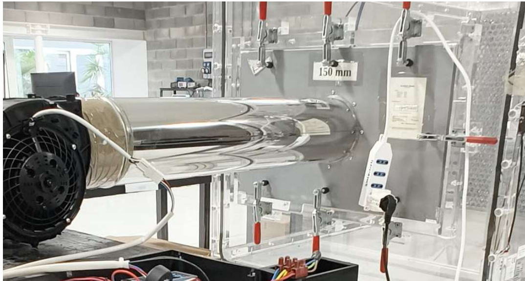
Figura 4.7: Tubo IEC utilizzato per i test effettuati al banco di portata
