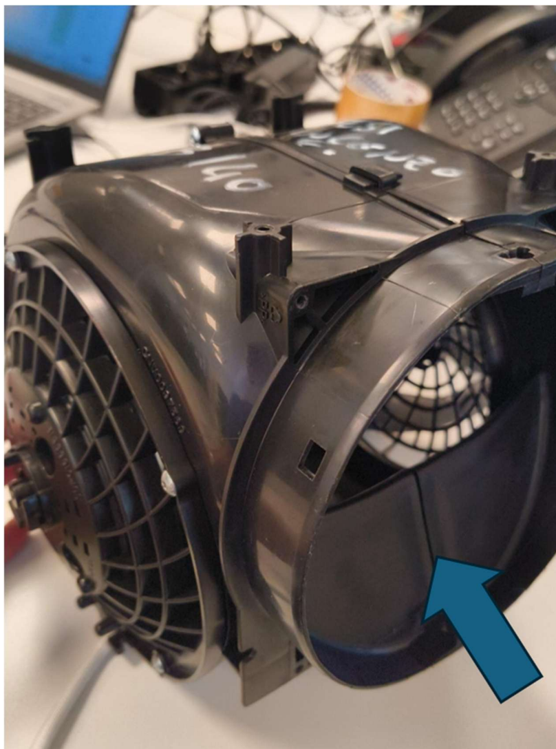
Figura 5.125: Setto (o Cut-off), presente nel convogliatore ETB 140
