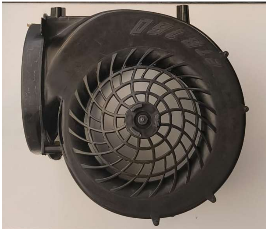
Figura 5.10: Vista laterale del convogliatore ETB 160
