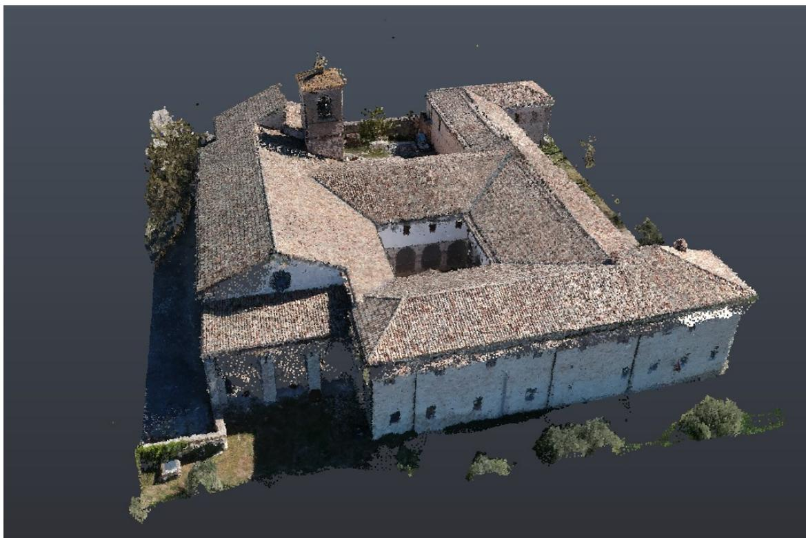
Figura 4.3 – Nuvola di punti derivata dal rilievo fotogrammetrico della copertura
