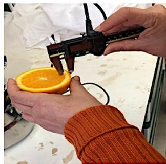
**Figura 10: Misurazione dell'altezza del frutto con calibro**
