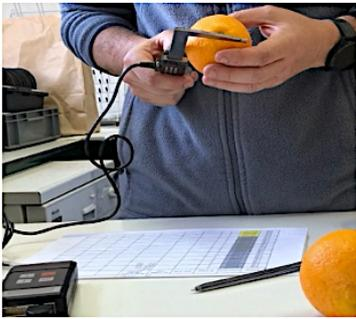
**Figura 9: Misurazione dello spessore della buccia con calibro**
