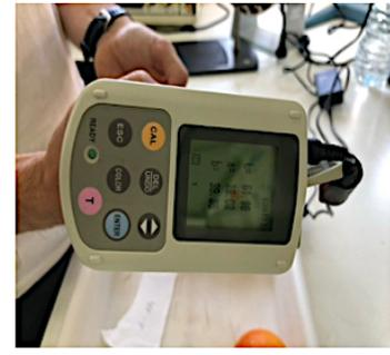
**Figura 11: Misurazione del colore tramite spettrofotometro**
