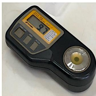
**Figura 12: Misurazione gradi brix con rifrattometro**
