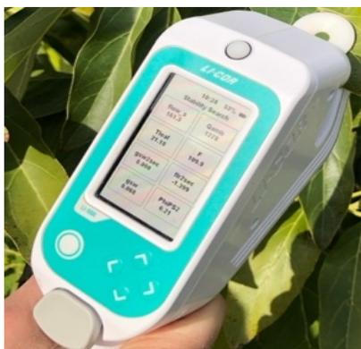
**Figura 6: Porometro Li-cor utilizzato per la misurazione della conduttanza stomatica**
