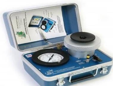
**Figura 7: Camera di pressione portatile utilizzata nello studio per misurare il potenziale idrico**
