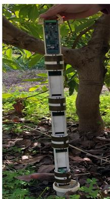
**Figura 4:** *Sensore utilizzato per misurare l'umidità del suolo*
