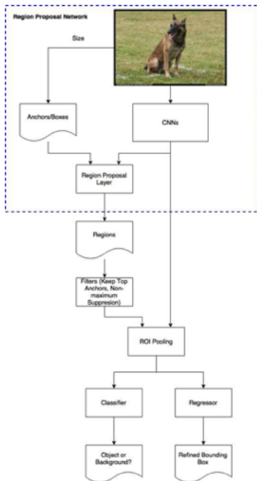
Figura 2.9: Architettura Faster R-CNN
