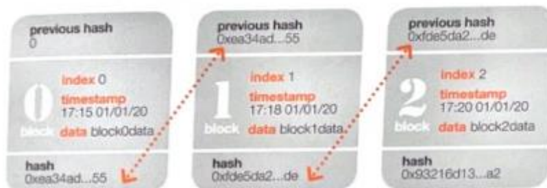
Figura 7 All'interno di blockchain, i blocchi di dati sono concatenati grazie all'hash function
