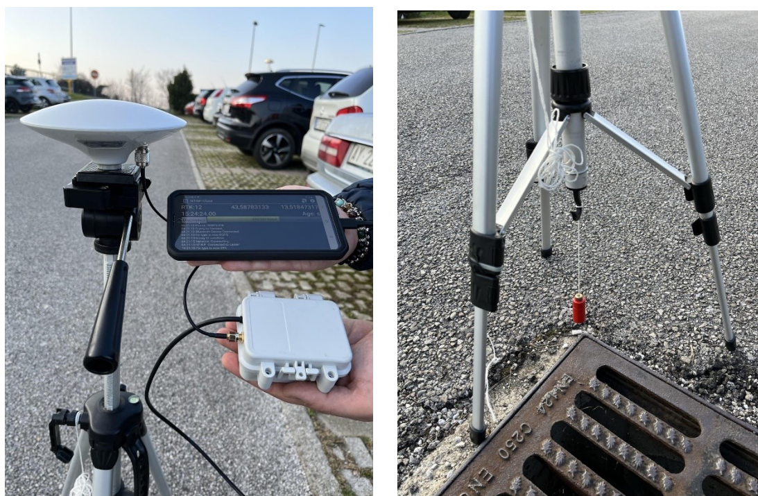
Fig.2 - Esecuzione delle coordinate GPS con antenna a piatto posizionata su un cavalletto in bolla con l'ausilio di un filo a piombo
