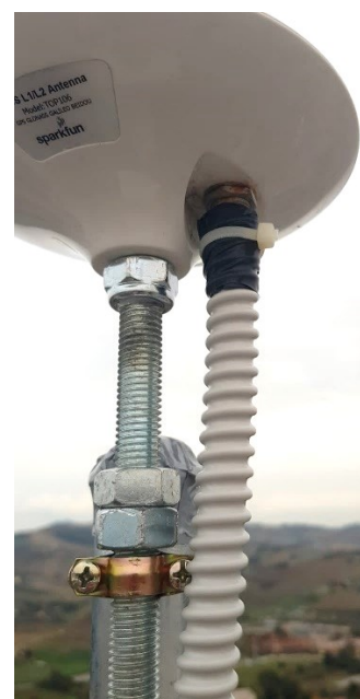
Fig.2 - Vista dell'interno della stazione base GPS-RTK (a) e della relativa antenna esterna (b)
