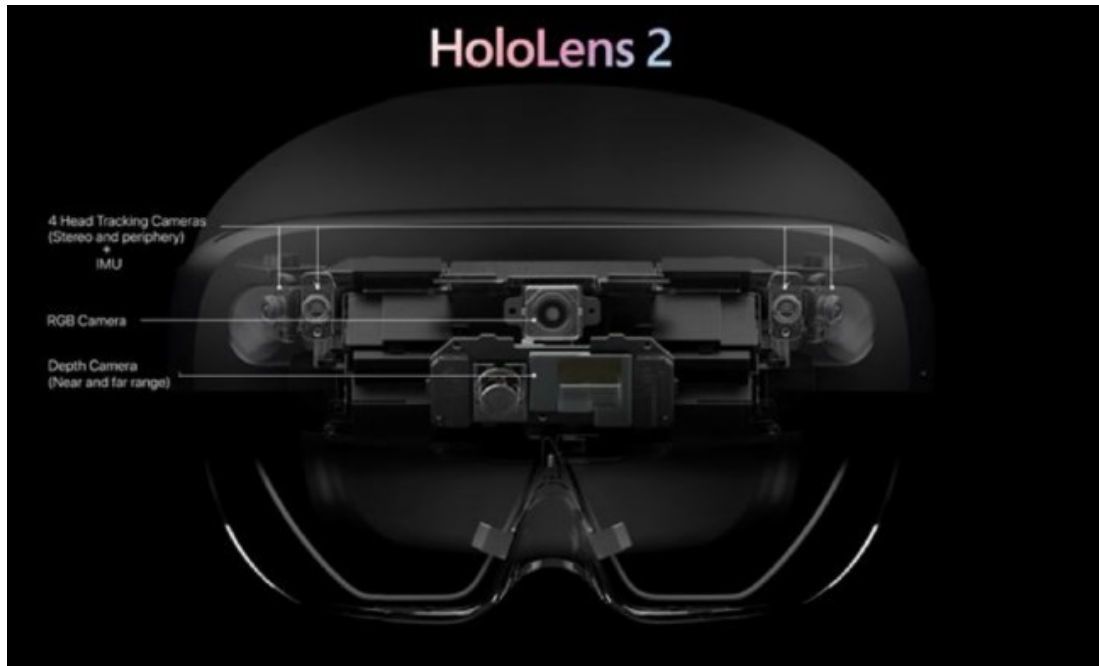
Fig.6 - La modalità ricerca di HoloLens 2 consente di accedere alla scala di grigi, alla telecamera di profondità ed ai sensori IMU del dispositivo. Questo integra la fotocamera a colori normalmente disponibile per le applicazioni
