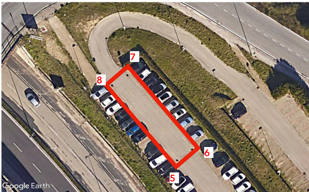
Fig.2 - Parcheggio _ Geolocalizzazione e misurazione dei quattro vertici interni dei quattro tombini che circoscrivono un rettangolo
