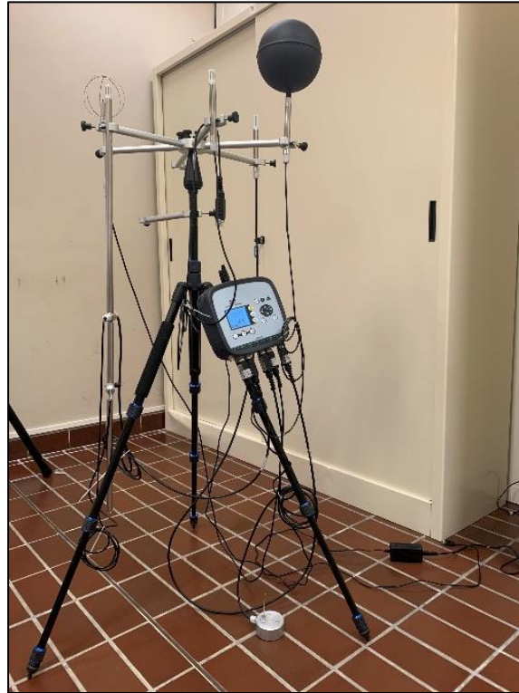
Figura 16 – stazione microclimatica Delta OHM HD32.1
