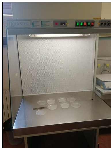
Figura 4-1: Cappa sterile per la semina in laboratorio.
