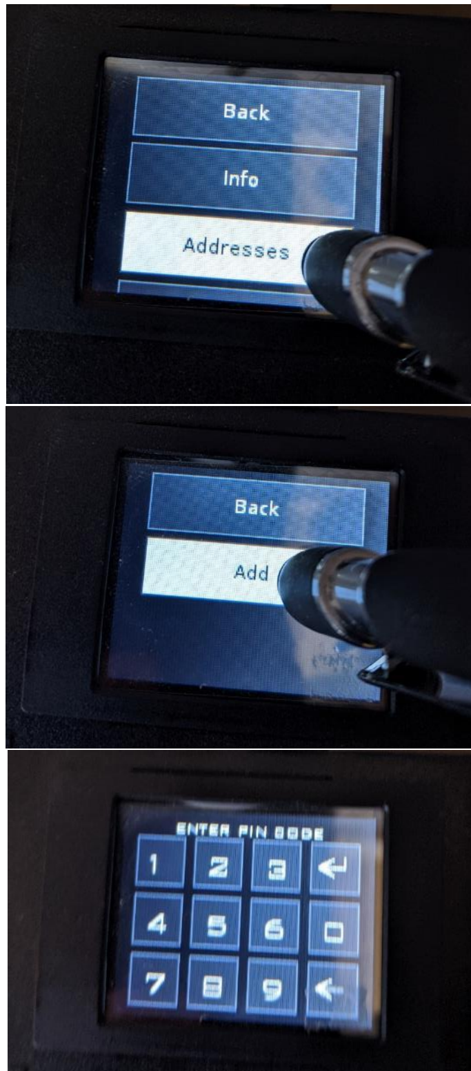
Immagine 7.6– Ripristino Router: assegnazione IP all'interfaccia ETH1 del router (2)
