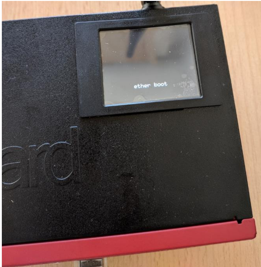
Immagine 3.5 – Display LCD del router riportante la scritta “ether boot”, a indicare che il sistema è in attesa del netbooting
