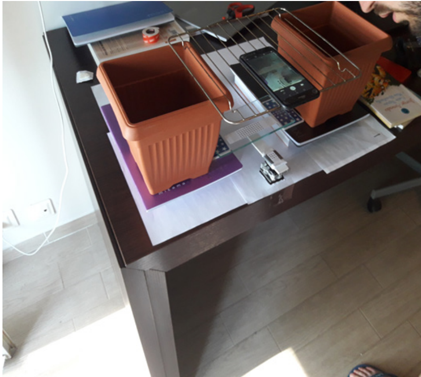
Figura 4.1: Foto del sistema per simulare la prova di Creep.
