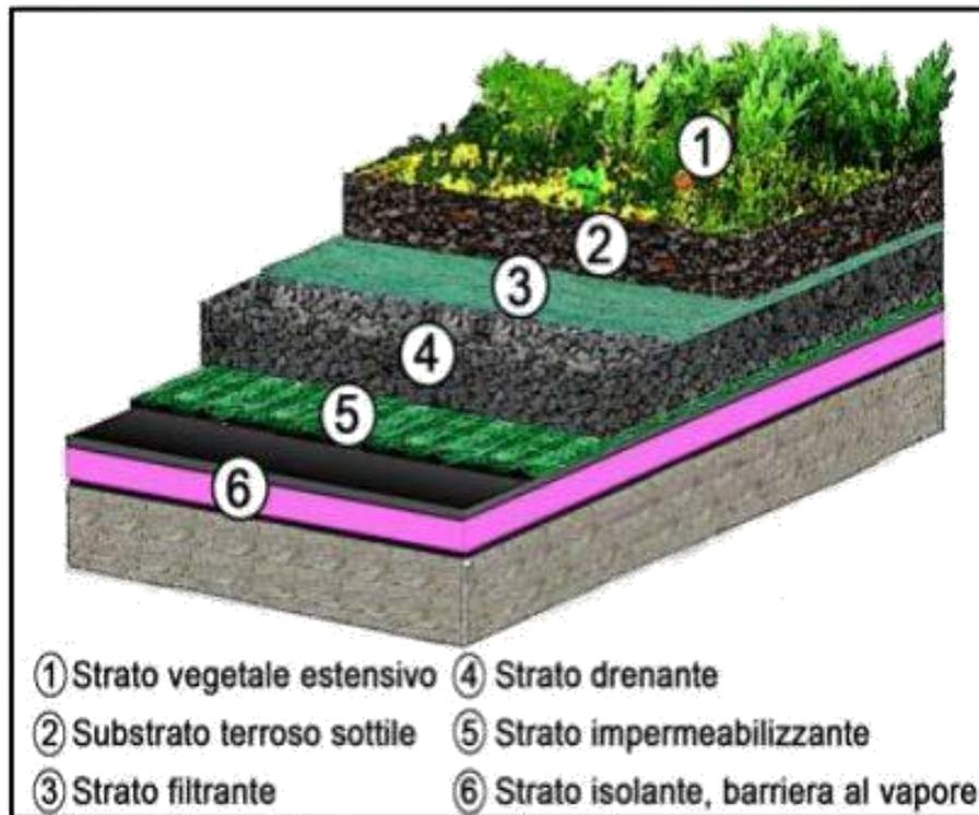
*Fig. 27 Esempio di schema dei vari strati che compongono un tetto verde estensivo*
