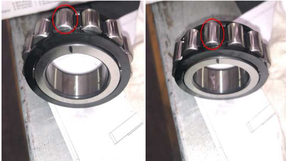
Figura 5.5: Presenza del fault nel rullo
