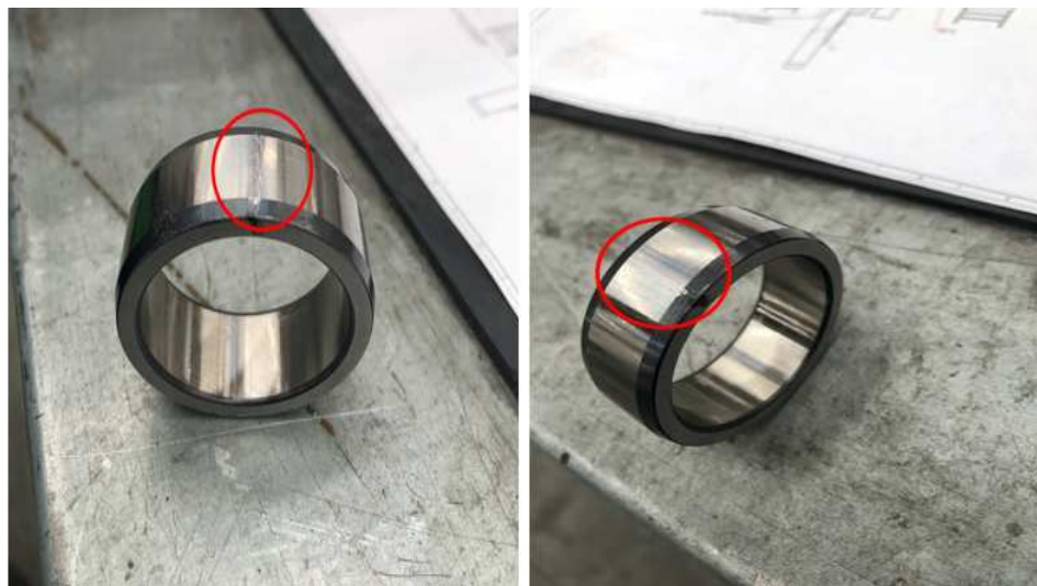
Figura 5.4: Presenza del fault nell'anello interno
