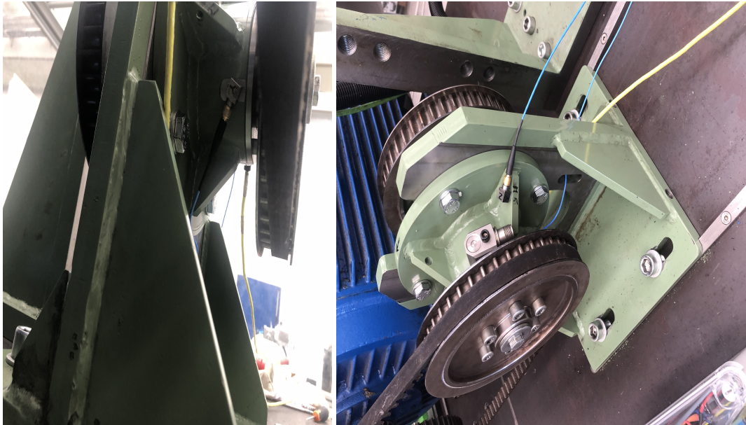
Figura 5.7: Posizionamento dei sensori nel banco da prova
